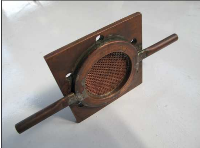
Slika 15b. Vodeni hladnjak
