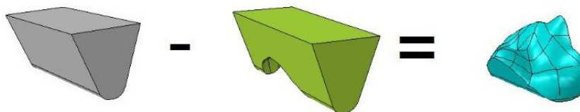
Slika 6.17. Postupak dobivanja konačnog modela ispuna
