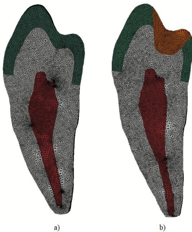
Slika 6.24. Presjek mreže konačnih elemenata na modelu a) zuba bez ispuna, b) zuba s kompozitnim ispunom
