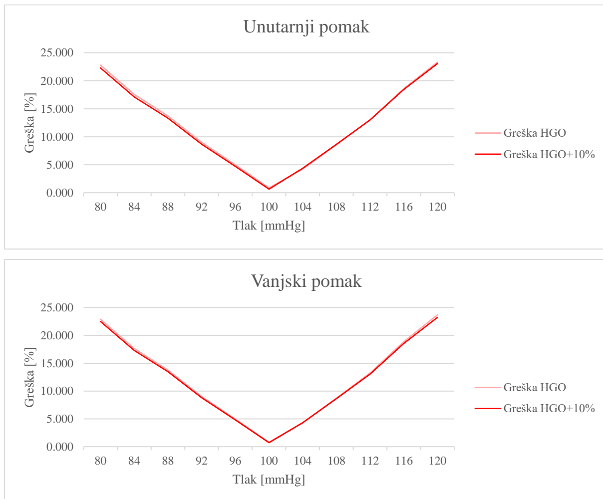
Slika 38. Relativna greška fitanja za Holzappel-Gasser-Ogden s jednom podjelom na unutarnjem radijusu (gornja slika) i vanjskom radijusu (donja slika)
