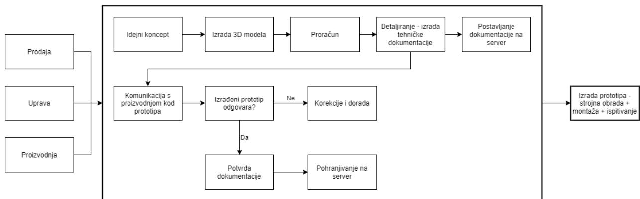
Slika 58. Shema rada konstrukcijskog ureda poduzeća OMV-INDOIL
