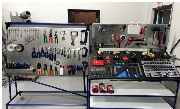
**Slika 11. 5S u načinu spremanja alata na radnom mjestu [13]**
