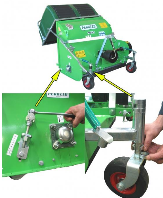
Slika 18. Sustav regulacije visine [18]
