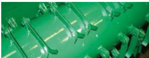
Slika 12. Rezni alati u obliku slova Y [14]
