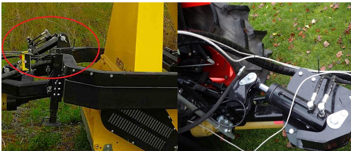
Slika 49. hidraulični cilindri za latelarni pomak i podešavanje visine rezanja [30]
