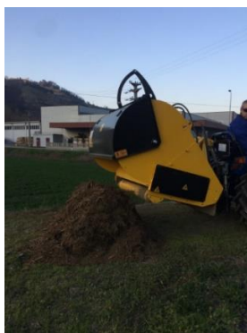
Slika 44. Istresanje prikupljene biomase [27]
