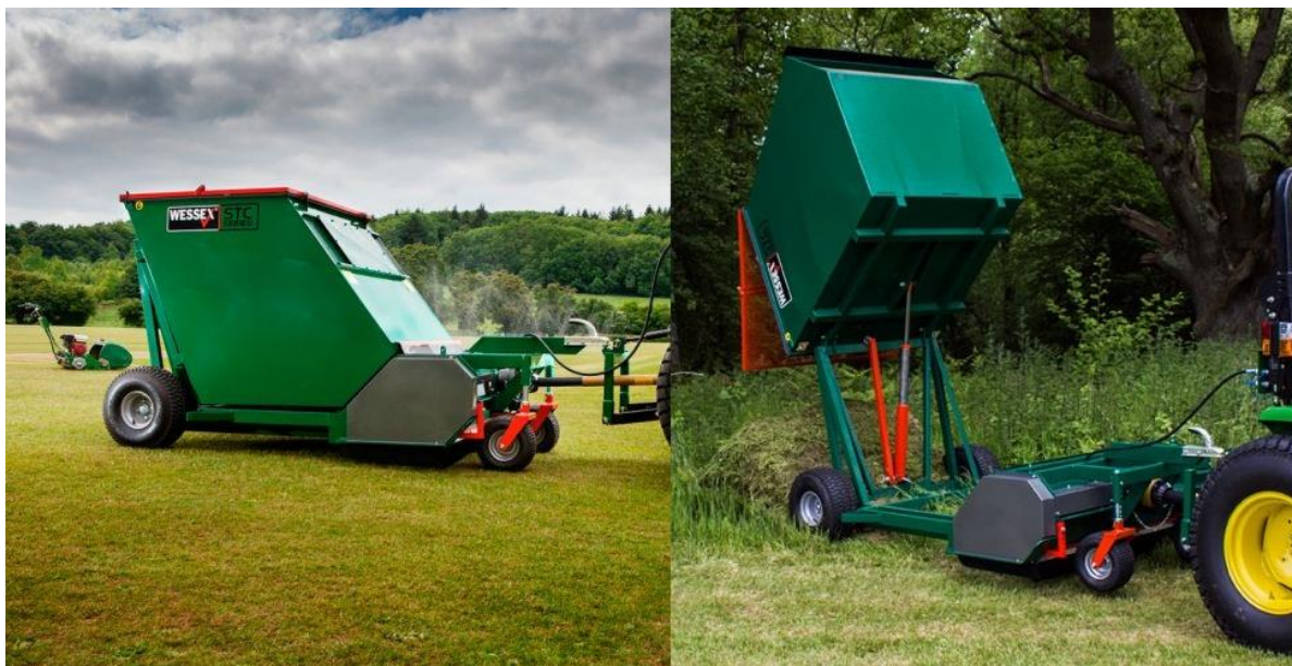
Slika 14. STC prikuljač tijekom košnje trave (L) i tijekom istresanja prikupljene biomase (D) [15] Karakteristike priključaka STC 120 i STC 180 su prikazane na u tablici 3.
