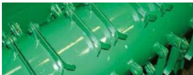
Slika 12. Rezni alati u obliku slova Y [14]
