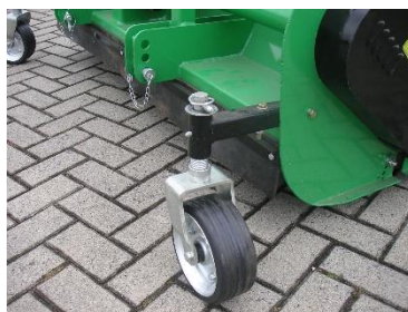
Slika 58. Kotači za regulaciju visine i zaštitna guma [33]
