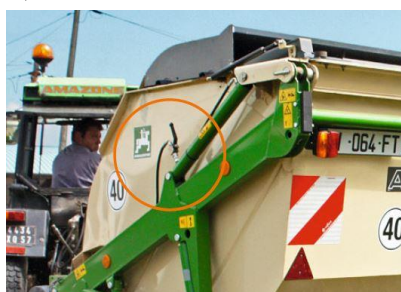
Slika 34. Sigurnosna hidraulična brava [24]
