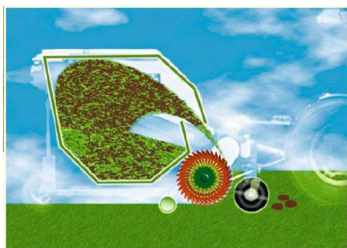
Slika 31. Presjek kosilice pri radu [24]
