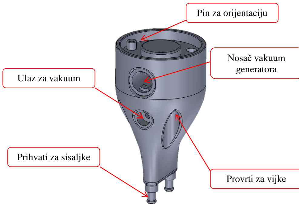
Slika 45. 3D model hvataljke
