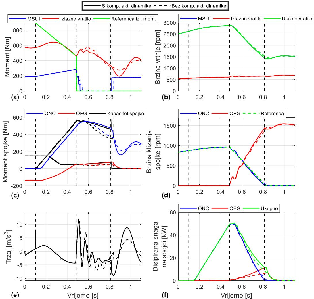
**Slika 43.** Simulacijski rezultati promjene stupnja prijenosa za LQR s i bez uključene kompenzacije aktuatora dinamike, s kompenzacijom propada momenta na izlaznom vratilu transmisije za vrijeme momentne faze,  $t_{TP} = 350$  ms,  $t_{IP} = 350$  ms i zatvoreni pretvarač momenta
