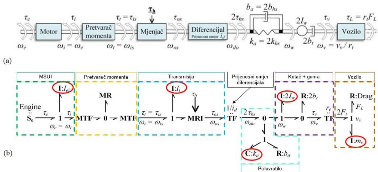
Slika 2. Shematski prikaz pogona vozila[1][11] (a) i vezni dijagram pogona vozila (b)
