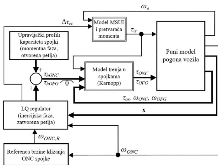
Slika 12. Blok dijagram upravljačke strukture promjene stupnja prijenosa [11]
