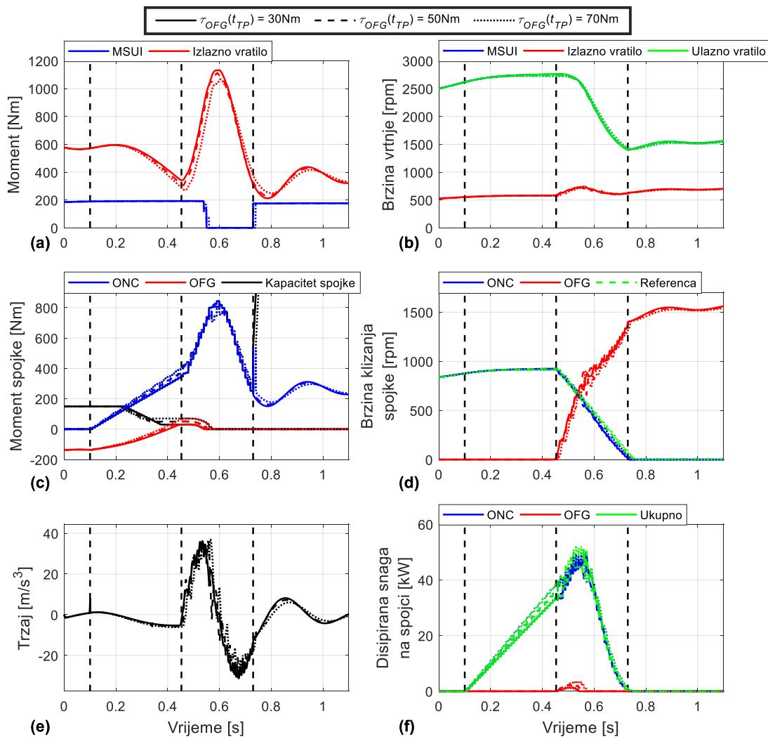
**Slika 24.** Simulacijski rezultati promjene stupnja prijenosa s obzirom na promjenu prijelaznog momenta OFG spojke  $\tau_{OFG}(t_{TP})$ , željeno trajanje momentne faze  $t_{TP} = 350$  ms i zatvoreni pretvarač momenta
