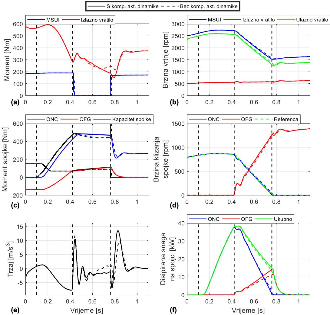
**Slika 42.** Simulacijski rezultati promjene stupnja prijenosa za LQR s i bez uključene kompenzacije aktuatorske dinamike, bez kompenzacije propada momenta na izlaznom vratilu transmisije za vrijeme momentne faze,  $t_{TP} = 250$  ms,  $t_{IP} = 350$  ms i otvoreni pretvarač momenta
