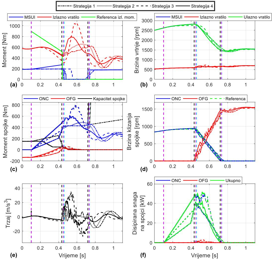
**Slika 40.** Simulacijski rezultati promjene stupnja prijenosa za različite upravljačke strategije,  $t_{TP} = 350$  ms,  $t_{IP} = 300$  ms i zatvoren pretvarač momenta
