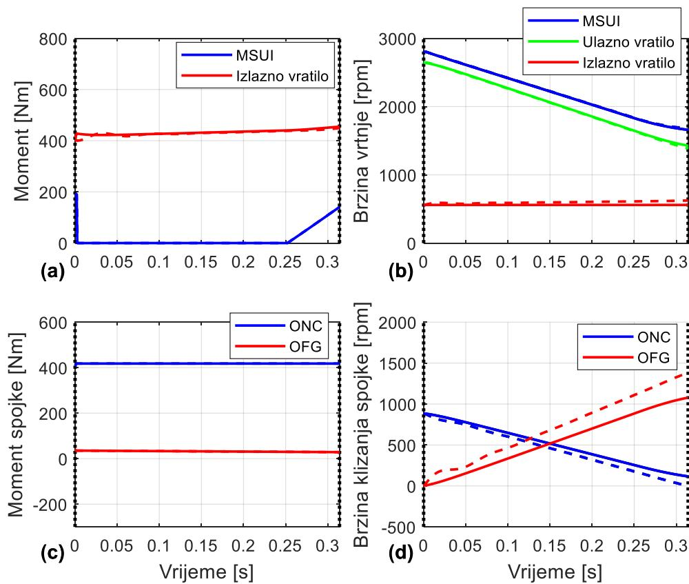
**Slika 10.** Usporedba reduciranih s punim modelom pogona vozila za vrijeme inercijske faze promjene stupnja prijenosa i slučaj otvorenog pretvarača momenta
