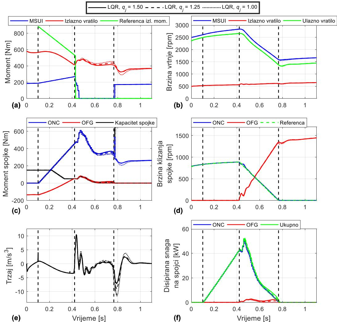
Slika 34. Simulacijski rezultati promjene stupnja prijenosa za LQR upravljanje s različitim koeficijentima penalizacije trzaja  $q_j$ , željeno trajanje inercijske faze  $t_{IP} = 350$  ms i otvoreni pretvarač momenta
