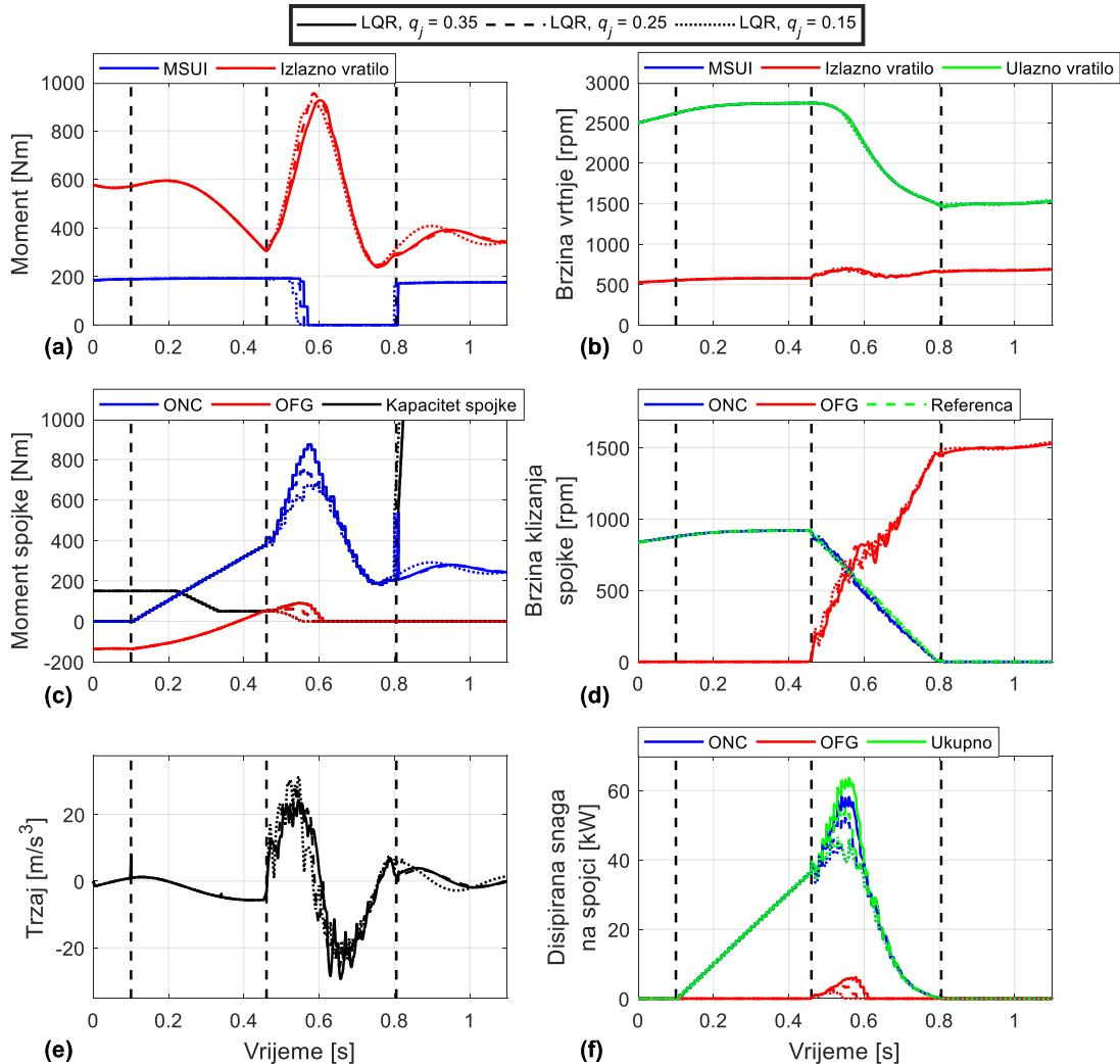
**Slika 32.** Simulacijski rezultati promjene stupnja prijenosa za LQR upravljanje s različitim koeficijentima penalizacije trzaja  $q_j$ , željeno trajanje inercijske faze  $t_{IP} = 350$  ms i zatvoreni pretvarač momenta
