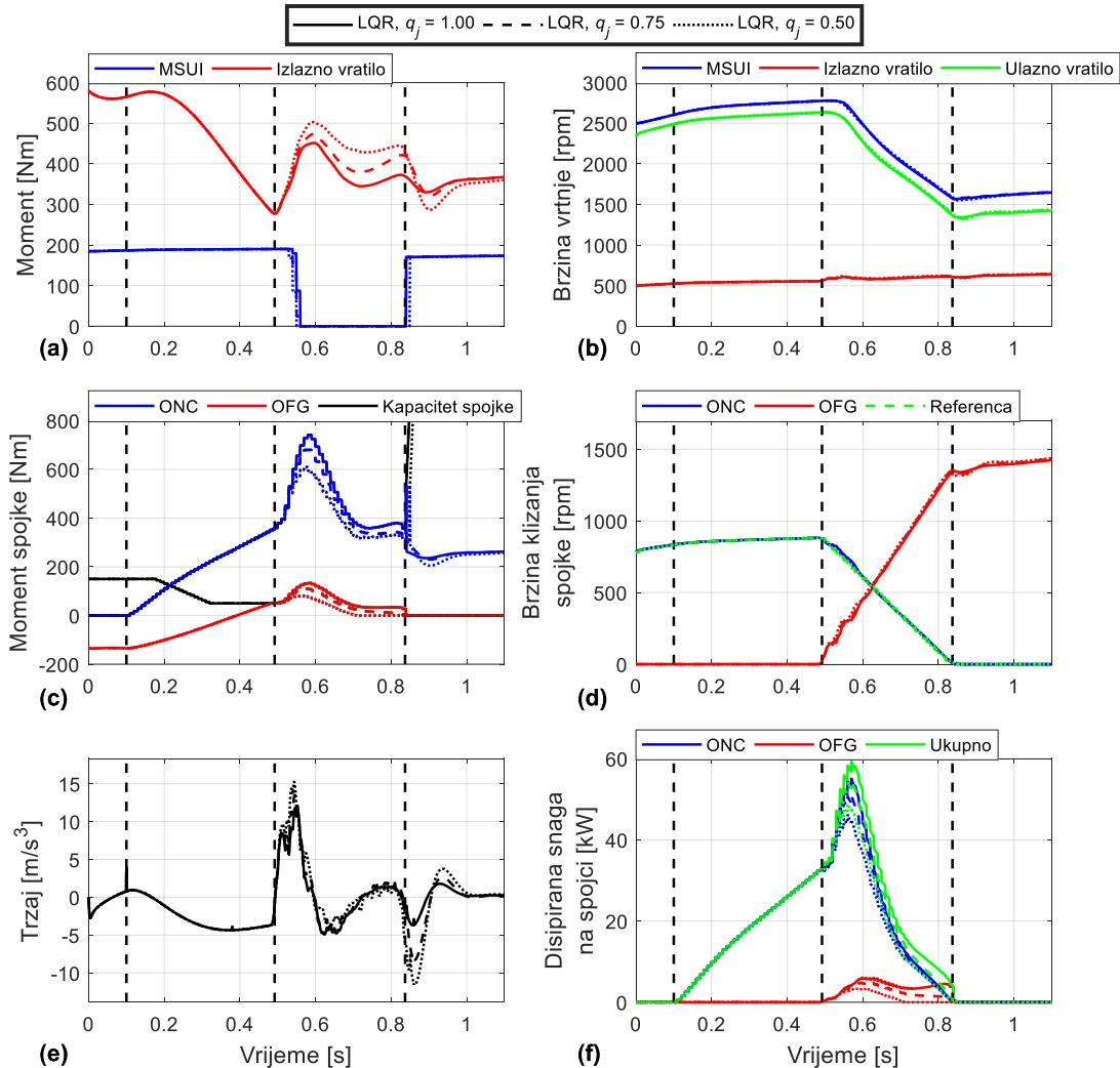
Slika 30. Simulacijski rezultati promjene stupnja prijenosa za LQR upravljanje s različitim koeficijentima penalizacije trzaja  $q_j$ , željeno trajanje inercijske faze  $t_{IP} = 350$  ms i otvoreni pretvarač momenta
