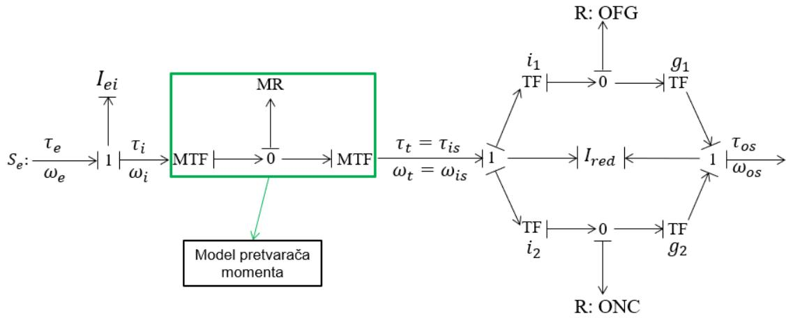
Slika 7. Vezni dijagram reduciranog modela pogona vozila
