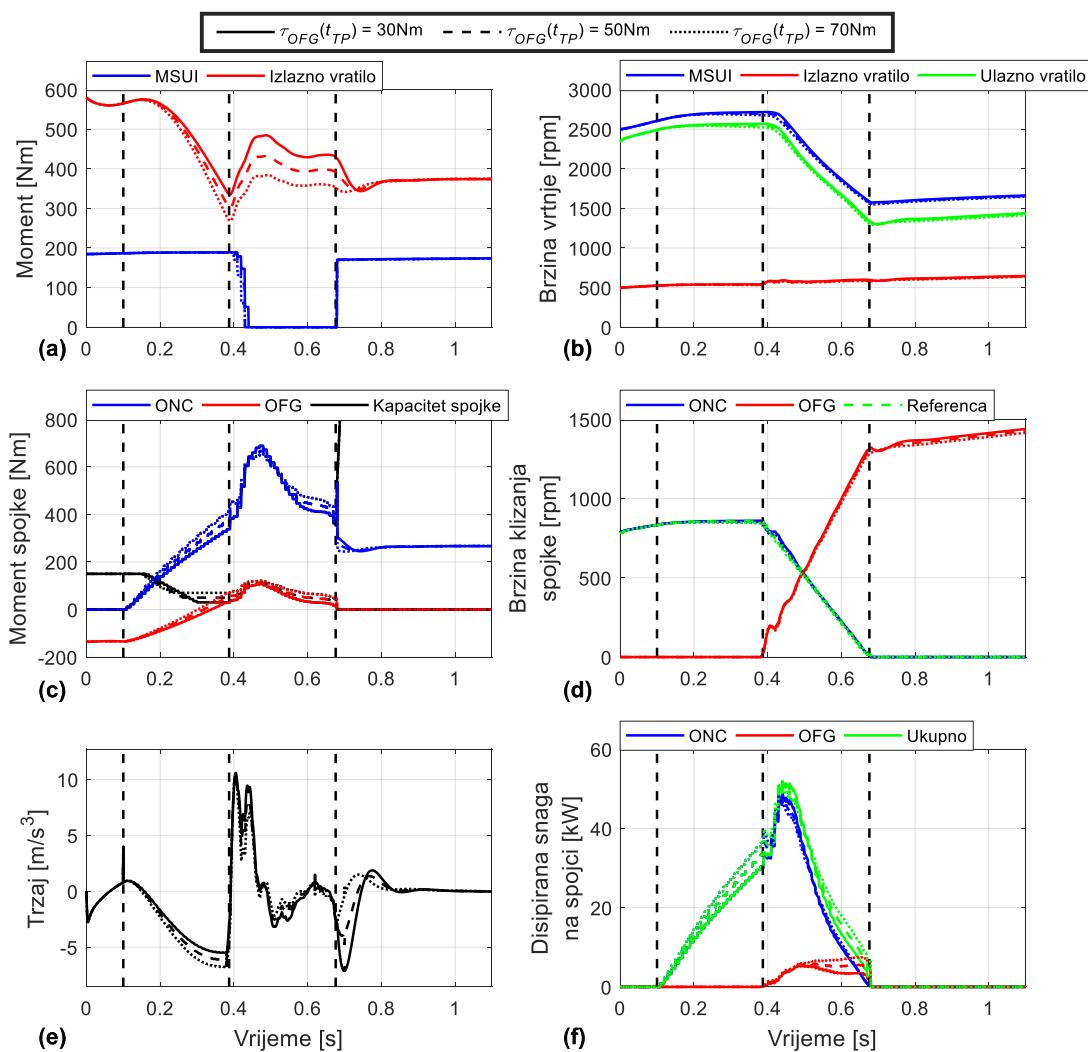
**Slika 22.** Simulacijski rezultati promjene stupnja prijenosa s obzirom na promjenu prijelaznog momenta OFG spojke  $\tau_{OFG}(t_{TP})$ , željeno trajanje momentne faze  $t_{TP} = 250$  ms i otvoreni pretvarač momenta
