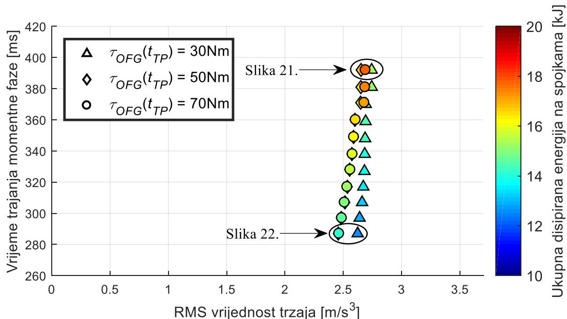
**Slika 20. Performanse upravljanja bez kompenzacije izlaznog momenta za različite prijelazne momente OFG spojke  $\tau_{OFG}(t_{TP})$  i različita trajanja momentne faze  $t_{TP}$  u slučaju otvorenog pretvarača momenta**
