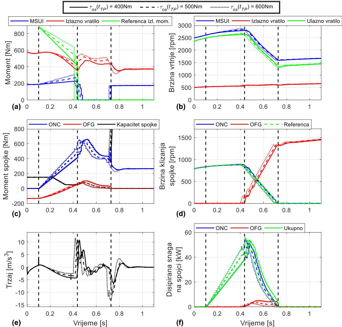
**Slika 26.** Simulacijski rezultati promjene stupnja prijenosa s obzirom na promjenu prijelaznog momenta izlaznog vratila  $\tau_{os}(t_{TP})$ , željeno trajanje momentne faze  $t_{TP} = 350$  ms i otvoreni pretvarač momenta
