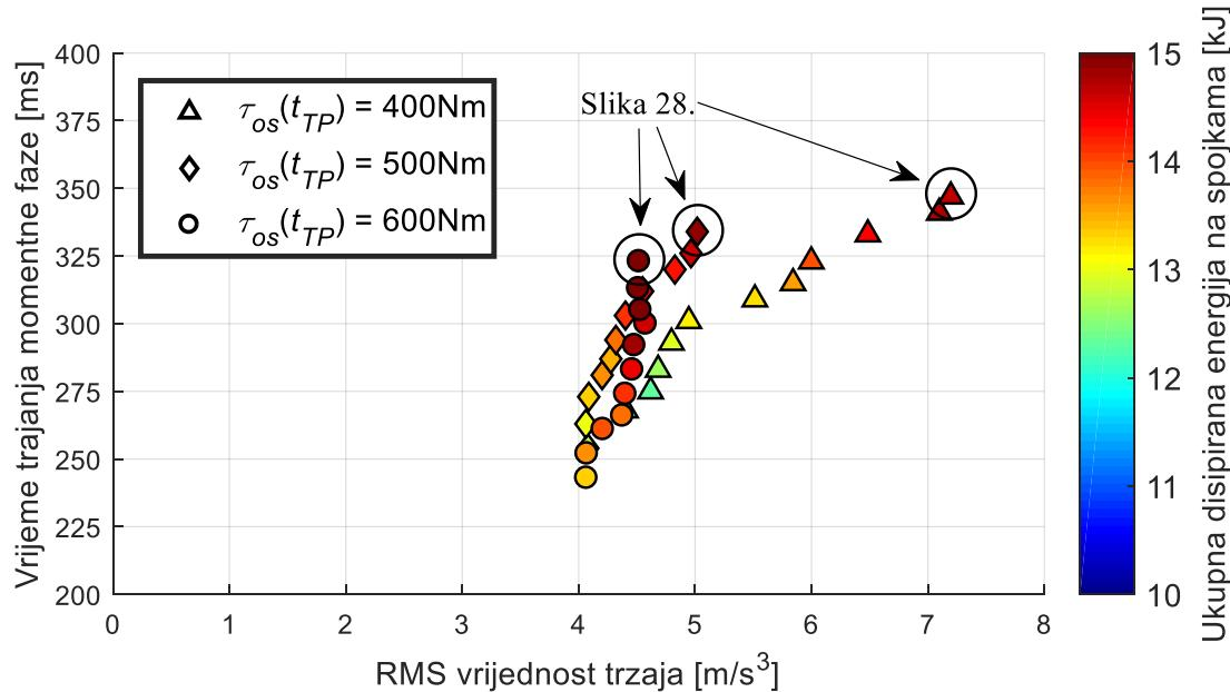
**Slika 27.** Performanse upravljanja s kompenzacijom izlaznog momenta za različite prijelazne momente na izlaznom vratilu  $\tau_{os}(t_{TP})$  i različita trajanja momentne faze  $t_{TP}$  u slučaju zatvorenog pretvarača momenta
