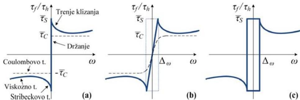
Slika 4. Model trenja: (a) statička karakteristika, (b) klasični model, (c) Karnoppov model[1]
