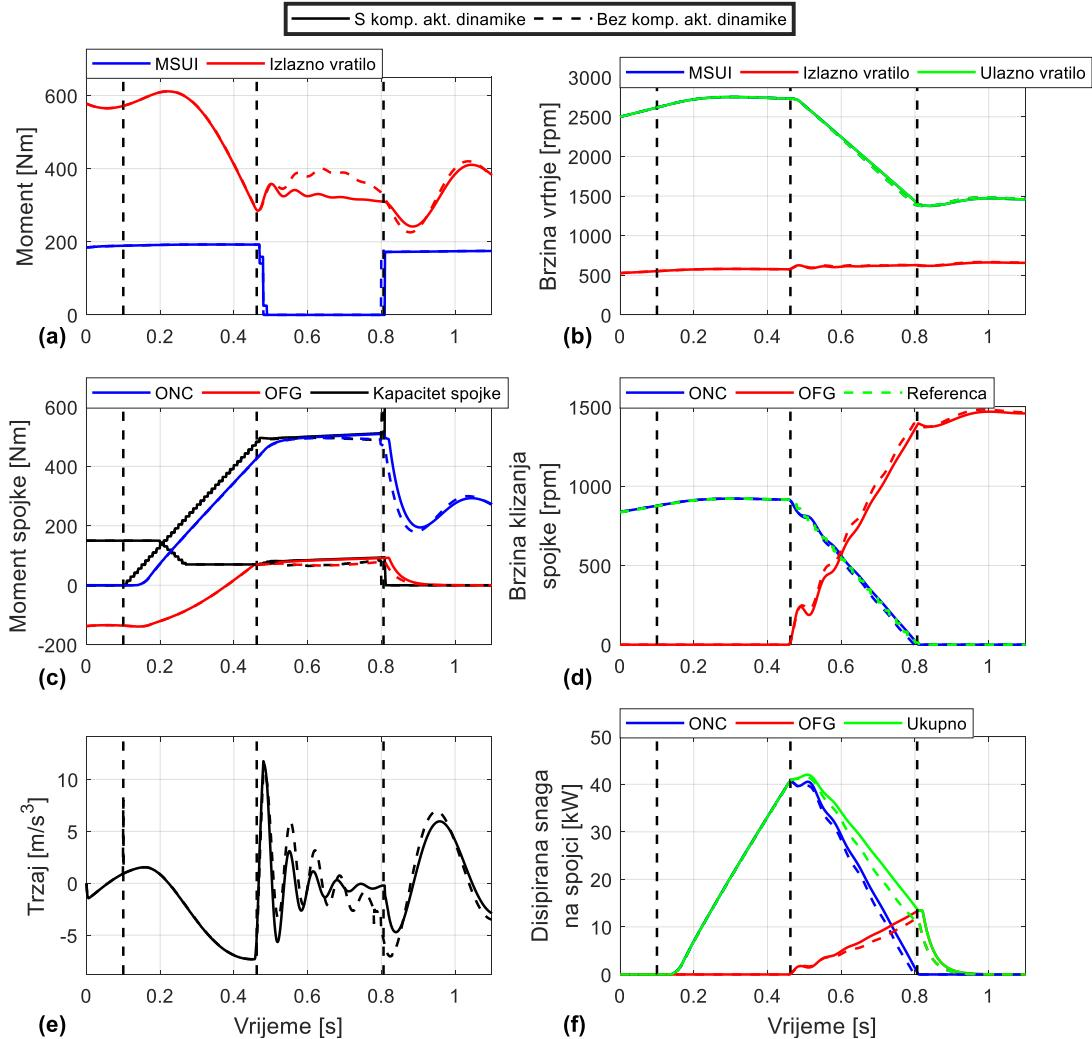
Slika 41. Simulacijski rezultati promjene stupnja prijenosa za LQR s i bez uključene kompenzacije aktuatora dinamike, bez kompenzacije propada momenta na izlaznom vratilu transmisije za vrijeme momentne faze,  $t_{TP} = 300$  ms,  $t_{IP} = 350$  ms i zatvoreni pretvarač momenta
