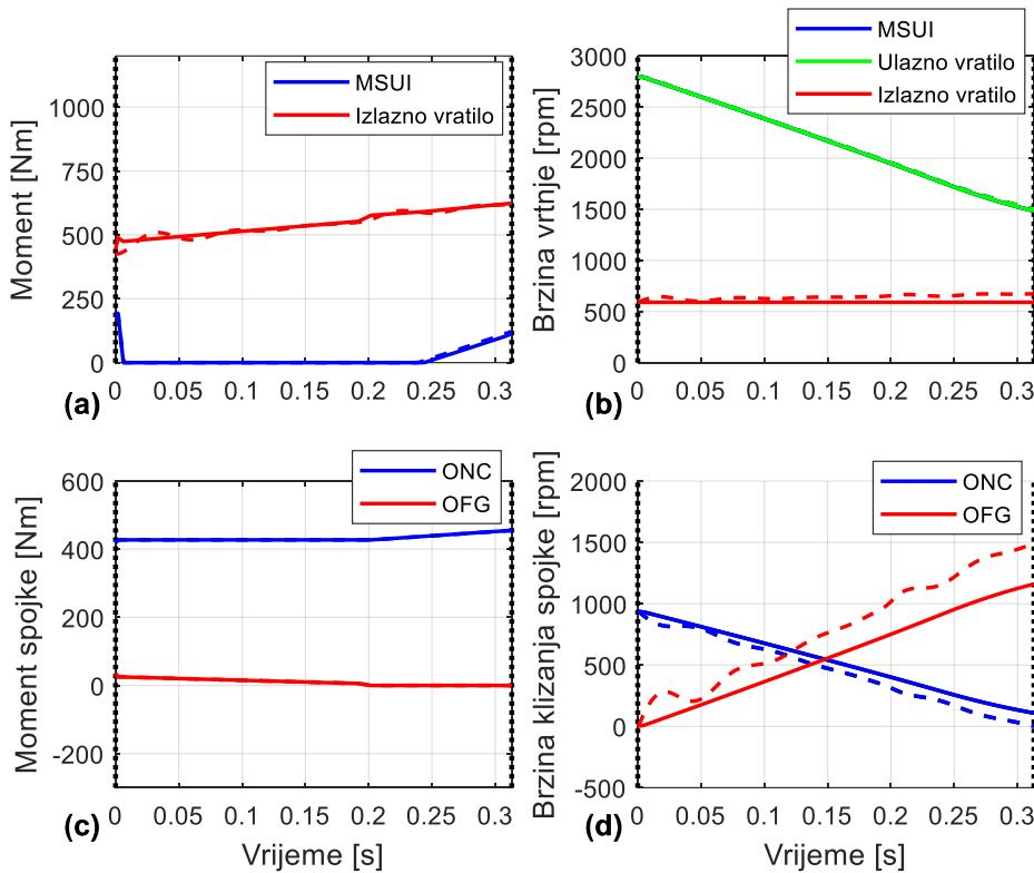
**Slika 8.** Usporedba reduciranih i punog modela pogona vozila za vrijeme inercijske faze promjene stupnja prijenosa i slučaj zatvorenog pretvarača momenta
