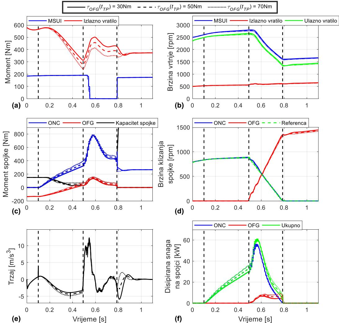
**Slika 21.** Simulacijski rezultati promjene stupnja prijenosa s obzirom na promjenu prijelaznog momenta OFG spojke  $\tau_{OFG}(t_{TP})$ , željeno trajanje momentne faze  $t_{TP} = 350$  ms i otvoreni pretvarač momenta
