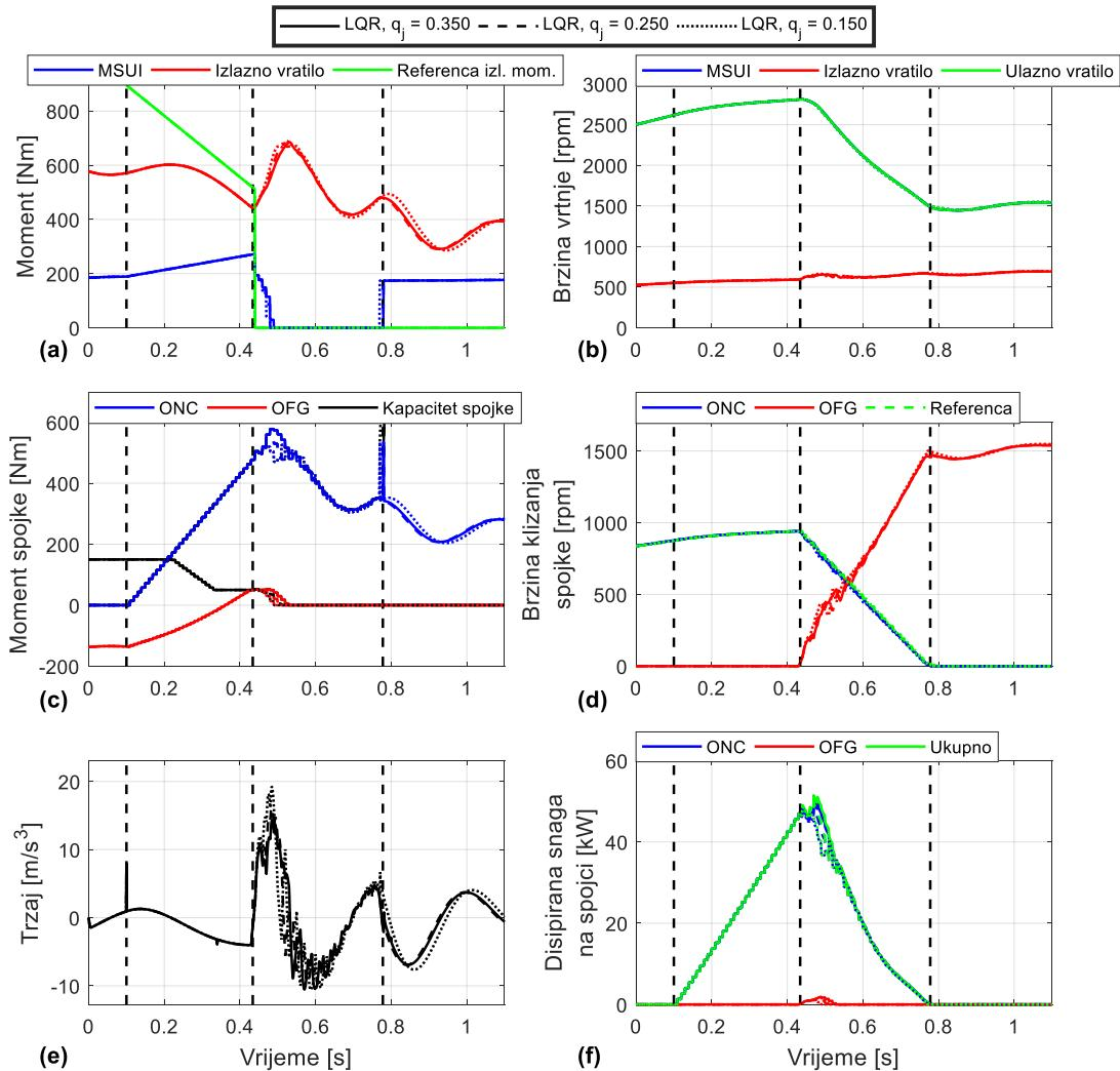
Slika 36. Simulacijski rezultati promjene stupnja prijenosa za LQR upravljanje s različitim koeficijentima penalizacije trzaja  $q_j$ , željeno trajanje inercijske faze  $t_{IP} = 350$  ms i zatvoreni pretvarač momenta
