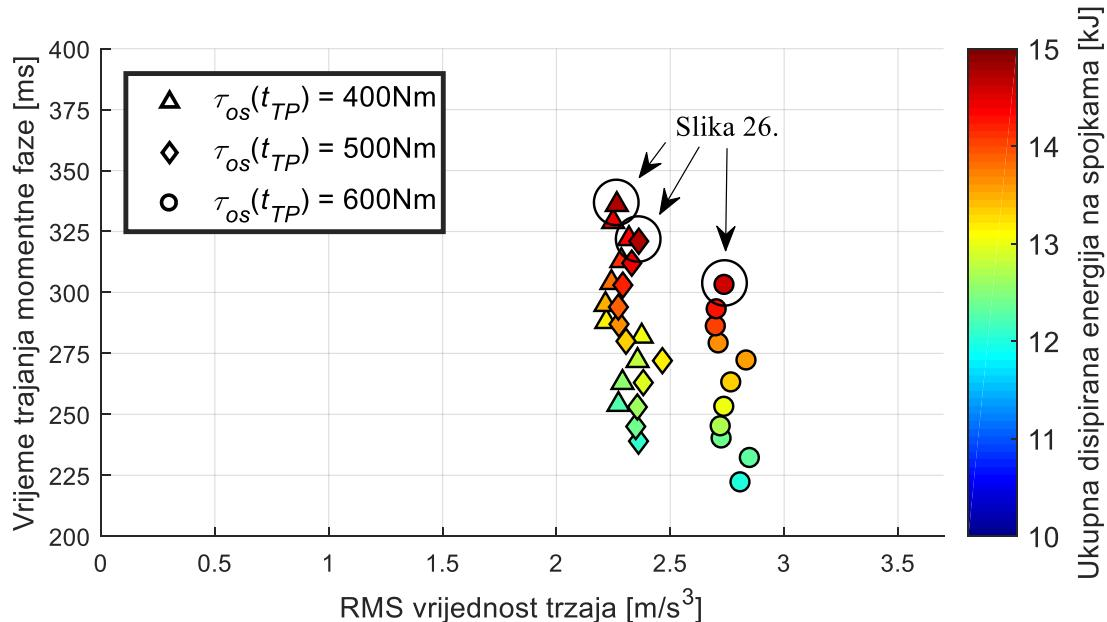
**Slika 25.** Performanse upravljanja s kompenzacijom izlaznog momenta za različite prijelazne momente na izlaznom vratilu  $\tau_{os}(t_{TP})$  i različita trajanja momentne faze  $t_{TP}$  u slučaju otvorenog pretvarača momenta
