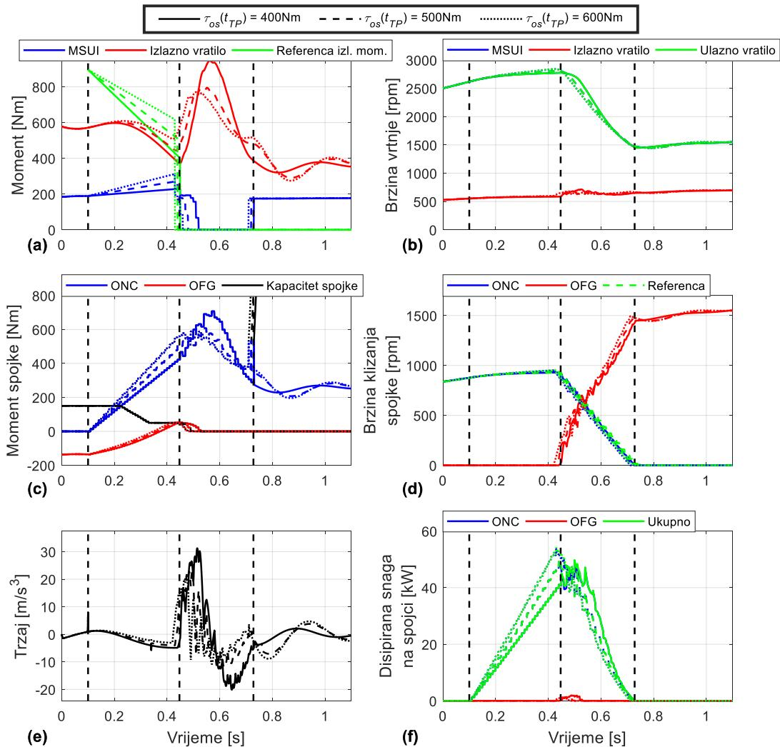
**Slika 28.** Simulacijski rezultati promjene stupnja prijenosa s obzirom na promjenu prijelaznog momenta izlaznog vratila  $\tau_{os}(t_{TP})$ , željeno trajanje momentne faze  $t_{TP} = 350$  ms i zatvoreni pretvarač momenta
