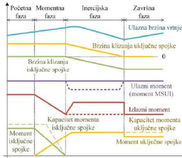
Slika 1. Uzlazna promjena stupnja prijenosa[1]
