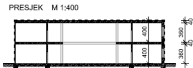
Slika 4. Presjek nZEB referentne zgrade za obrazovanje
