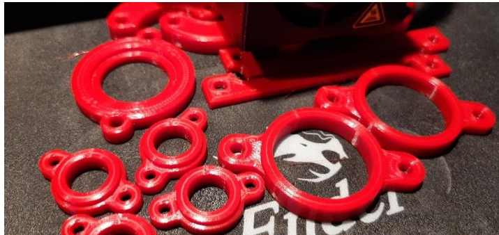
Slika 29. 3D printanje osigurača ležišta ležajeva
