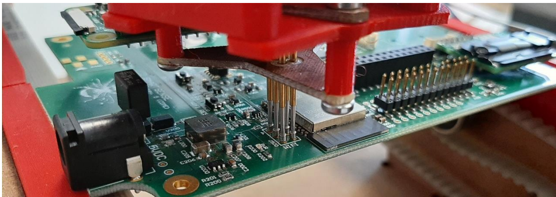
Slika 39. Ispravno ostvarivanje kontakta pri ispitivanju
