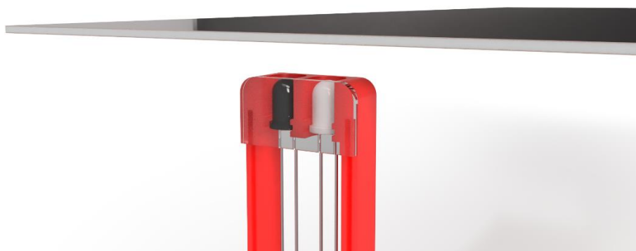
Slika 32. Infracrveni fotoosjetljivi par X osi
