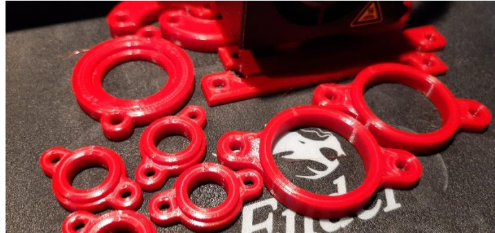
Slika 29. 3D printanje osigurača ležišta ležajeva
