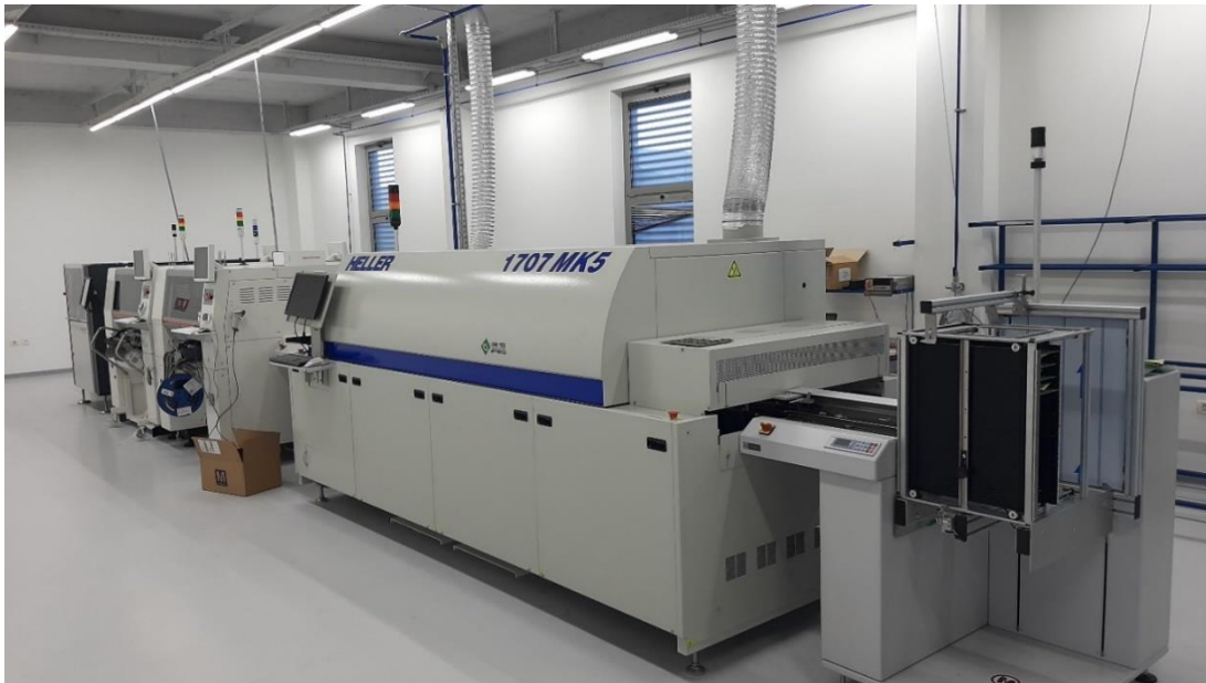
Slika 1. Proizvodna linija montaže elektroničkih tiskanih pločica
