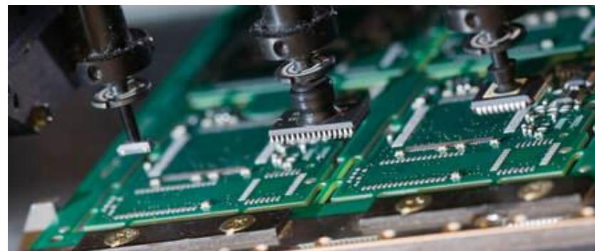
Slika 4. Pokupljanje komponenti vakuumskom mlaznicom [1]
