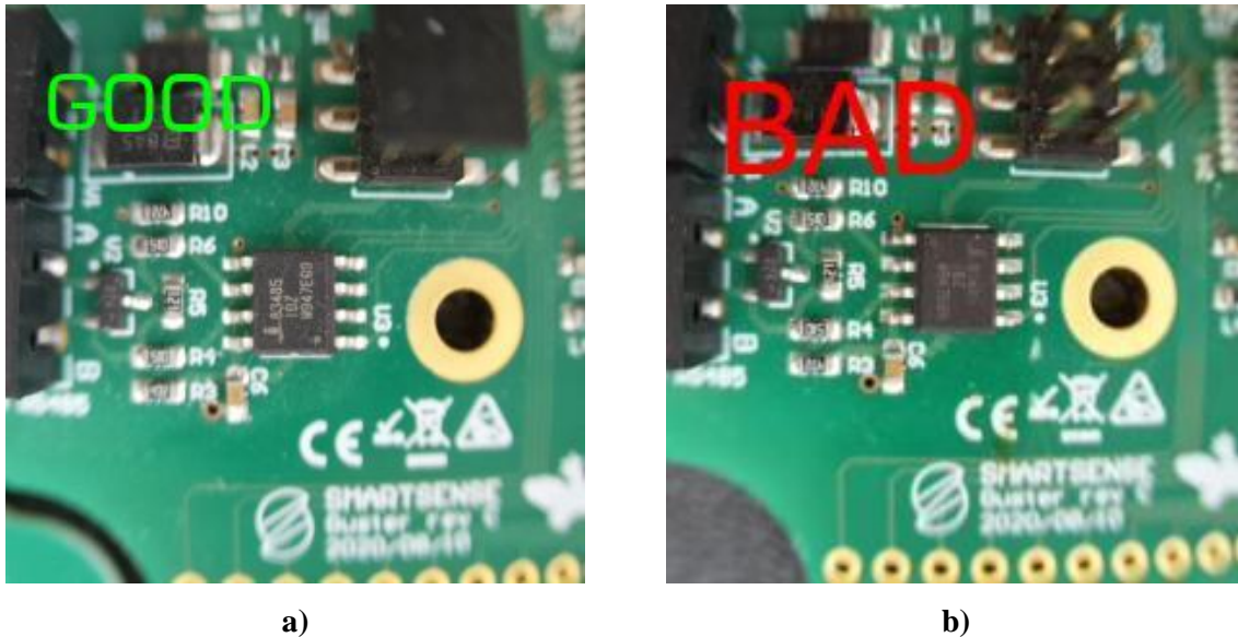
Slika 86. Uređene slike poslije obrade: a) Dobro orijentirana komponenta, b) loše orijentirana komponenta
