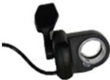
Slika 22. Ručica za upravljanje elektroničkim kočenjem [24]
