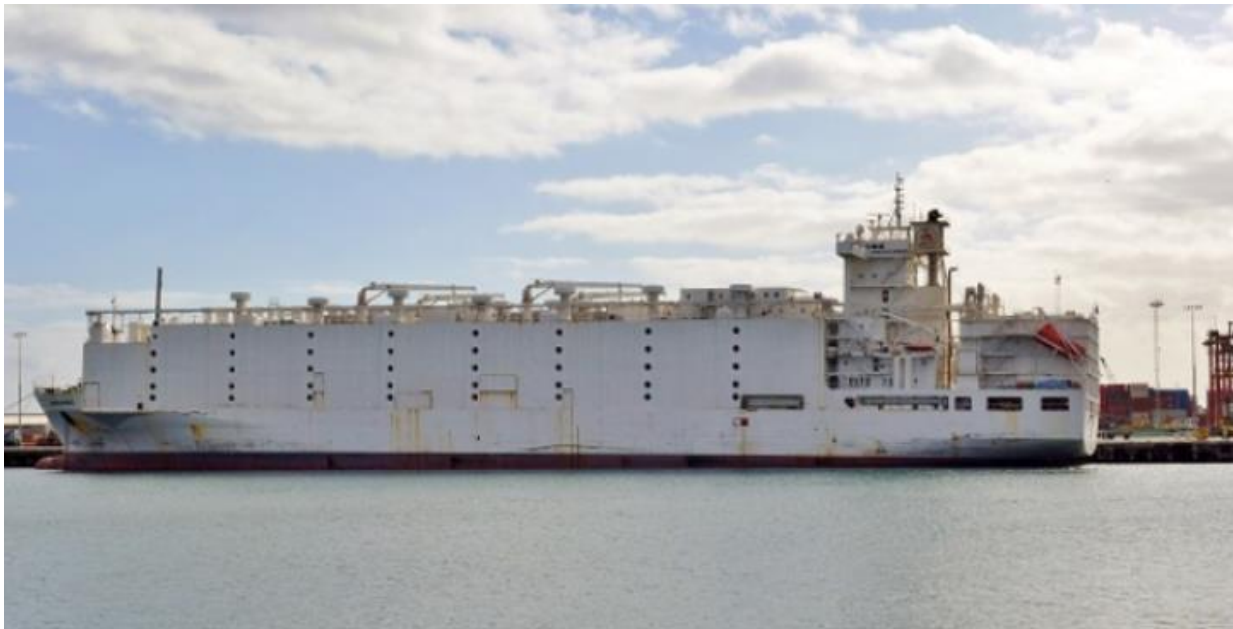
Slika 2. Zatvoreni tip broda za prijevoz žive stoke "Awassi Express" [2]
