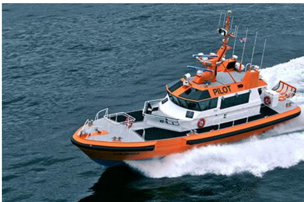
Slika 1. Plovilo izrađeno od aluminijske legure
