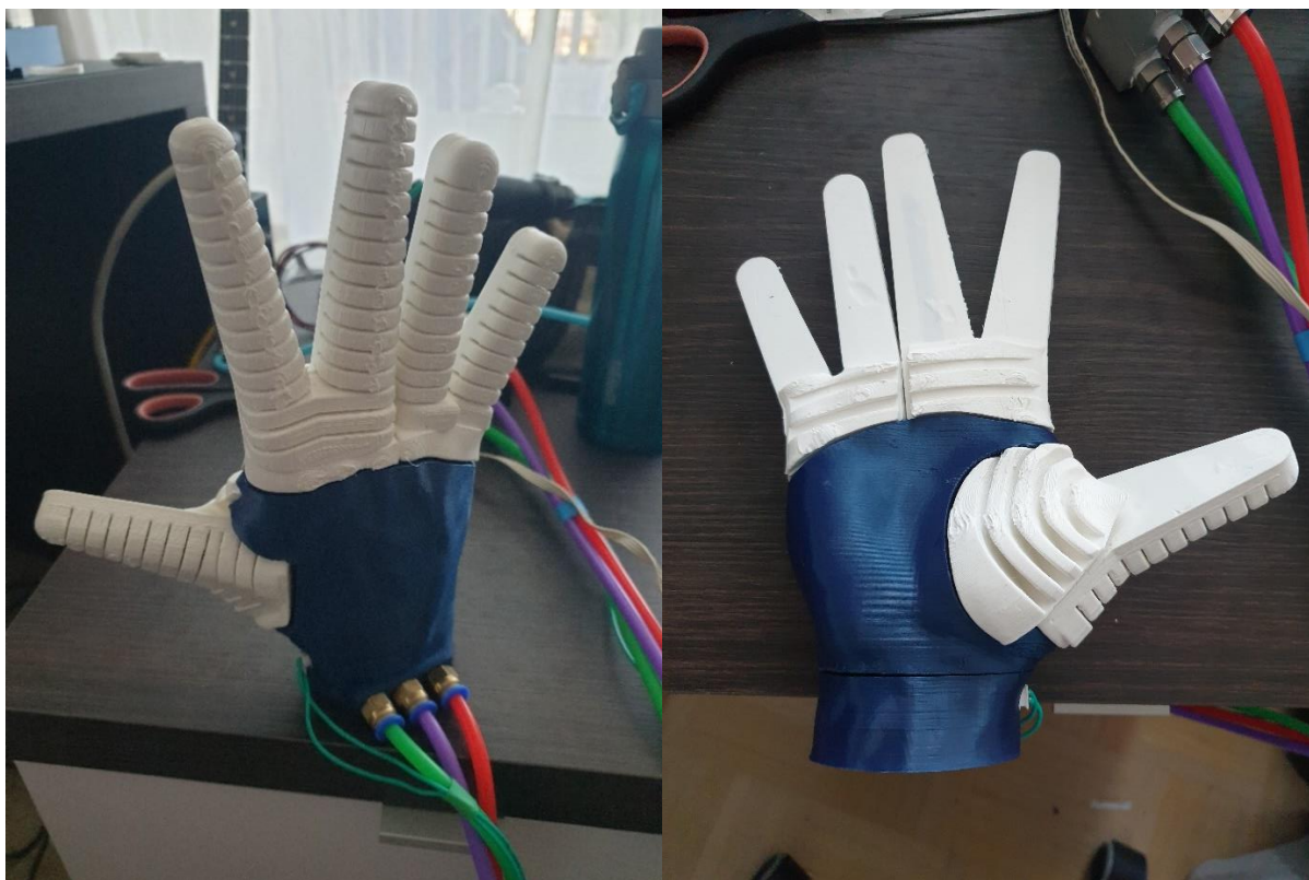
Slika 88. Izrađeni prototip antropomorfne robotske šake
