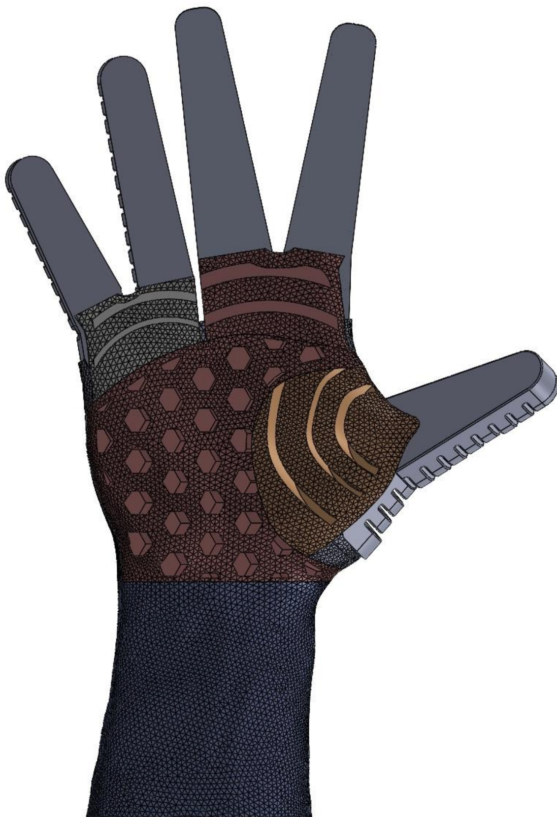
Slika 85. Konceptualni dizajn antropomorfne mekane robotske šake sa teksturama na dlanu
