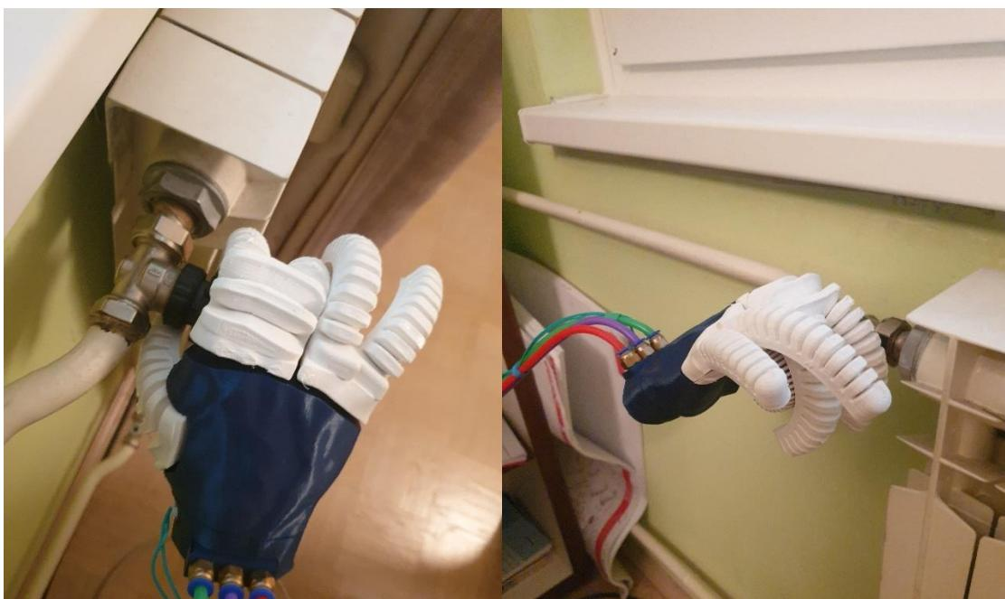
**Slika 90. Puni hvat mekane robotske šake oko ventila radijatora**
