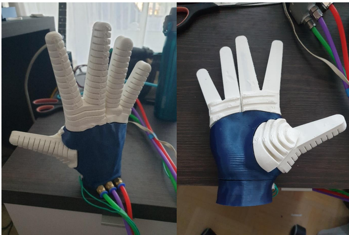
Slika 88. Izrađeni prototip antropomorfne robotske šake
