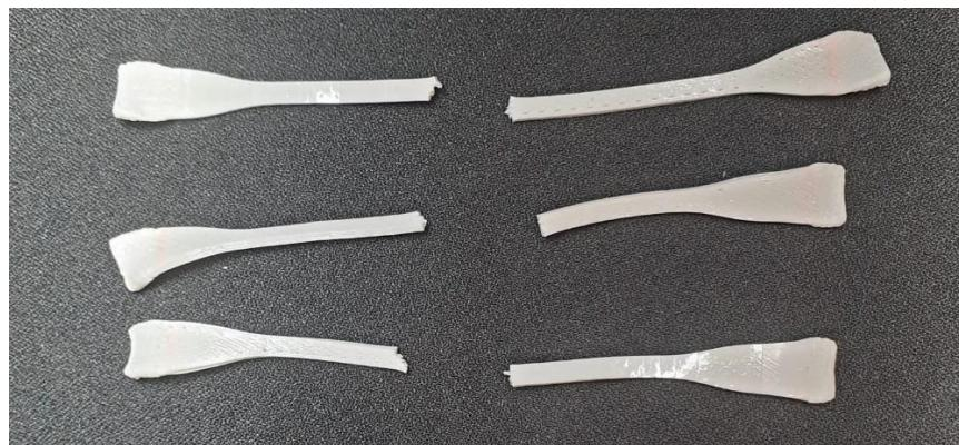
**Slika 12. Uzorci uspješnog vlačnog ispitivanja materijala**
