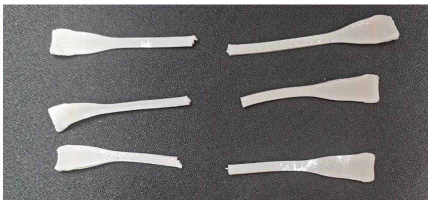
Slika 12. Uzorci uspješnog vlačnog ispitivanja materijala
