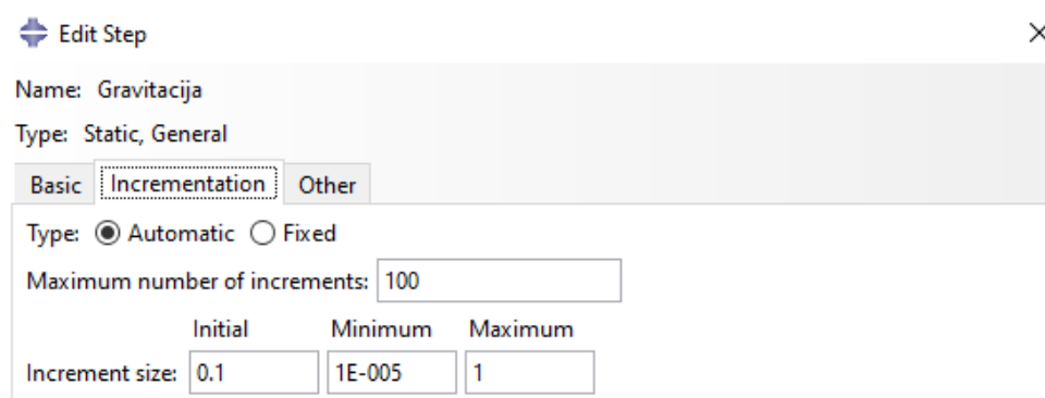
Slika 40. Odabir vremenskih varijabli za gravitacijsko opterećenje
