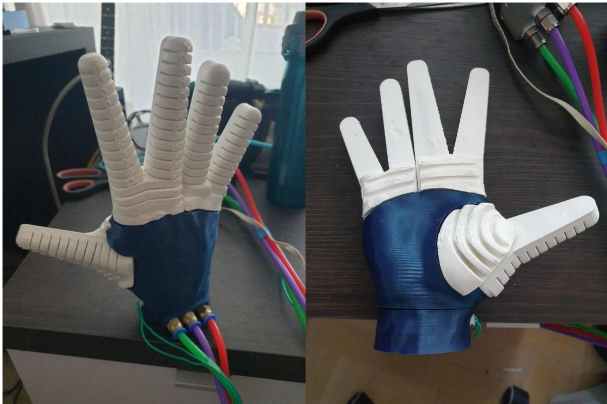
Slika 88. Izrađeni prototip antropomorfne robotske šake
