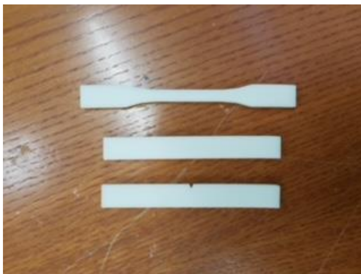
Slika 5.1. Ispitna tijela za ispitivanje mehaničkih svojstava
