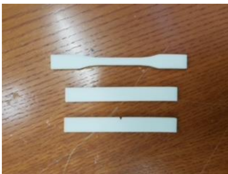
Slika 5.1. Ispitna tijela za ispitivanje mehaničkih svojstava
