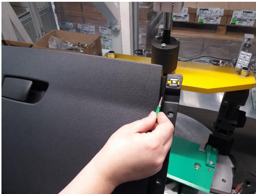
Slika 33. Provjera zazora etalomom
