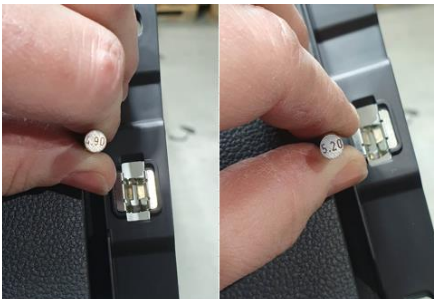
Slika 21. Preliminarna provjera zazora između kutije i poklopca
