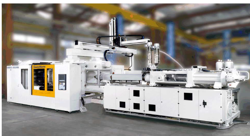
Slika 6. Linija za injekcijsko prešanje [5]
