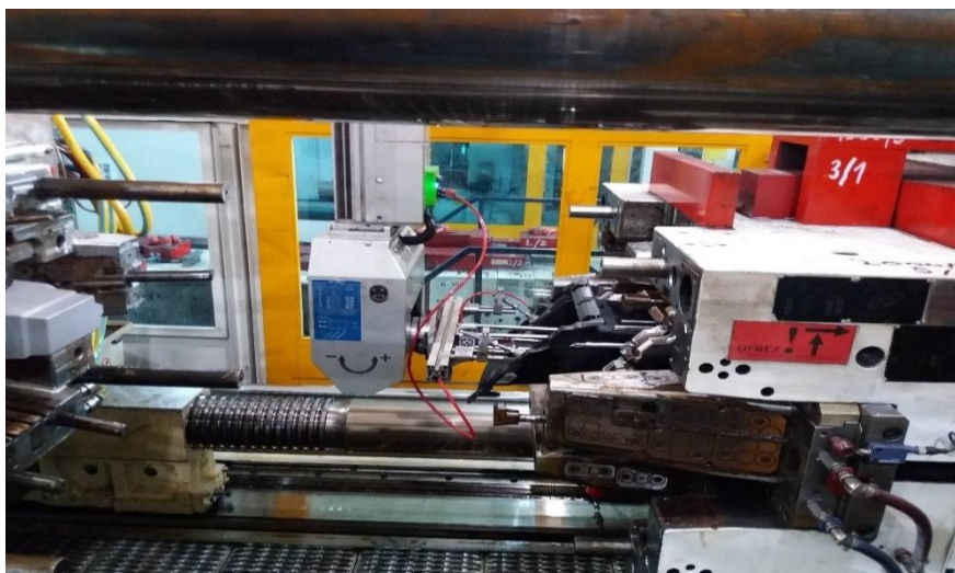
Slika 8. Vadenje otpreska iz kalupa
