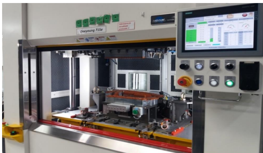
Slika 12. Zavarivanje (spajanje) poklopca
