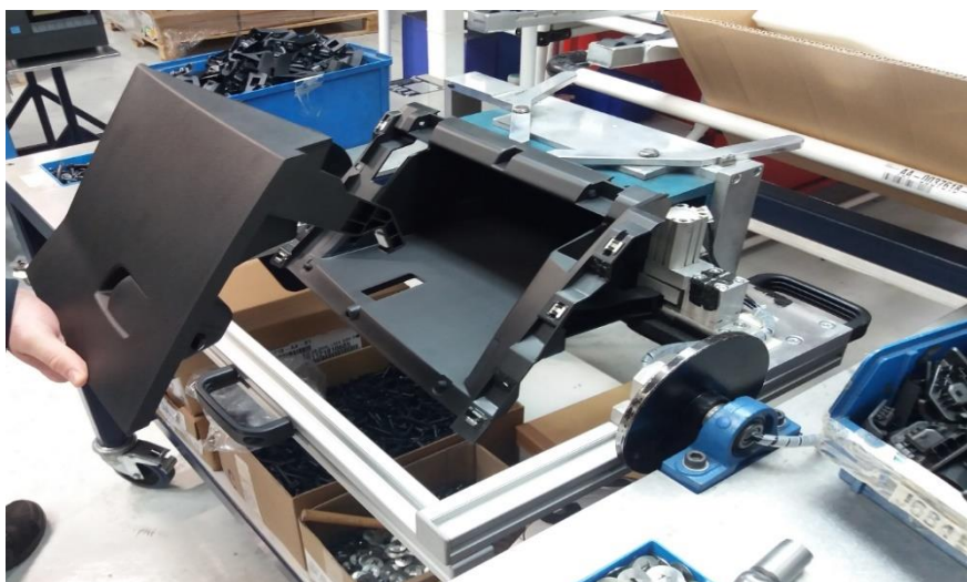
Slika 13. Montaža poklopca na kutiju pretinca
