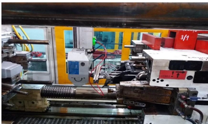
Slika 8. Vadenje otpreska iz kalupa
