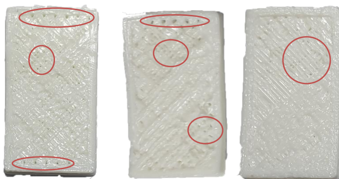
Slika 63. Poroznost na testnim uzorcima
