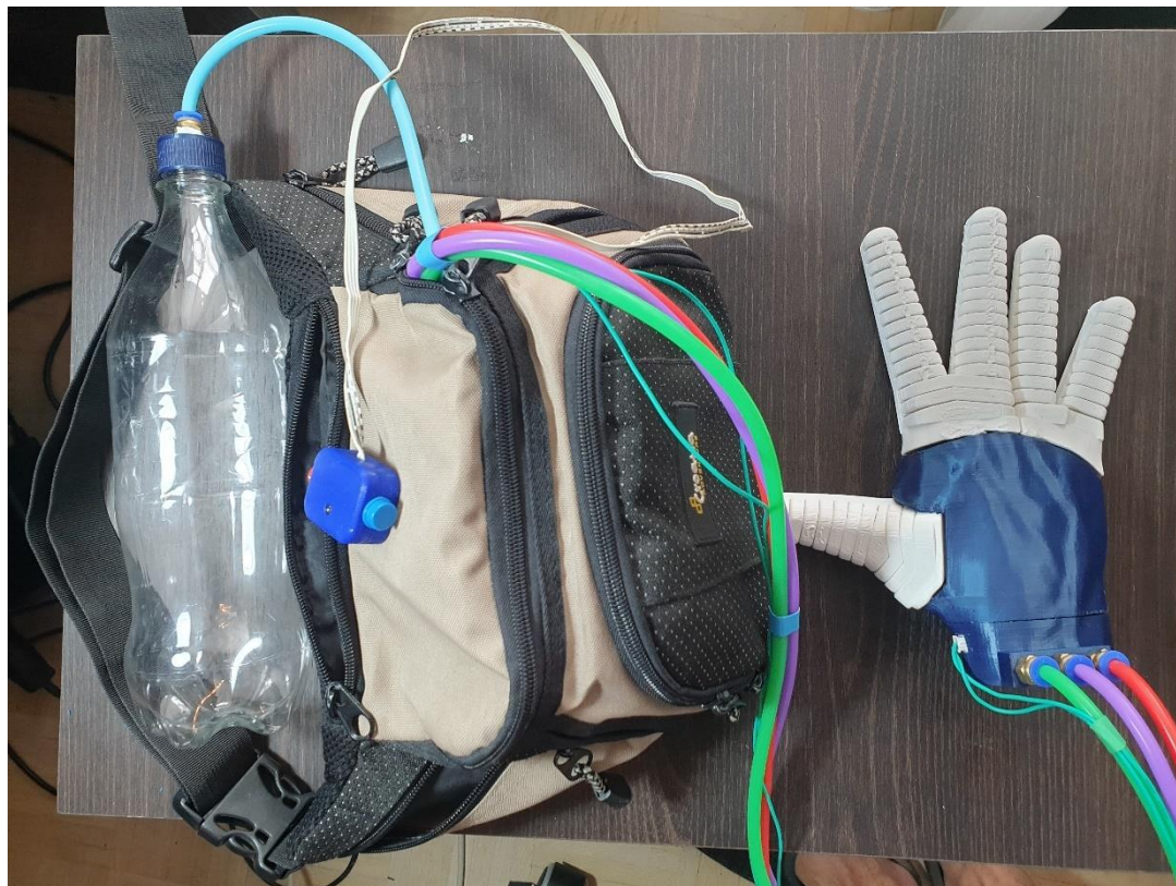
Slika 68. Konačan izgled sustava proteze
