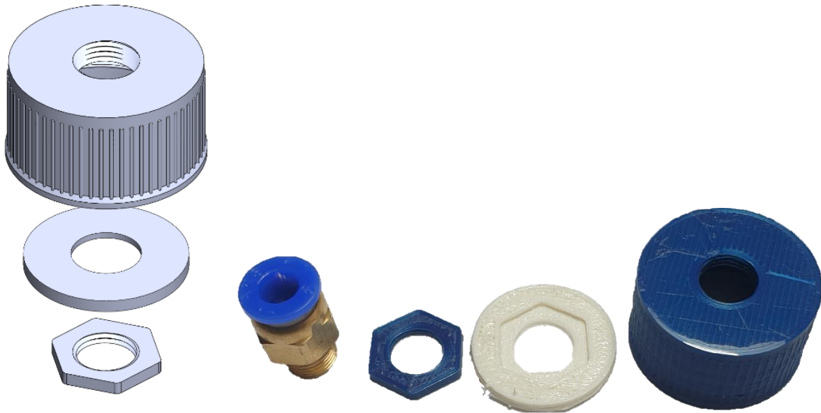
Slika 57. 3D model čepa (lijevo), isprintani dijelovi (desno)
