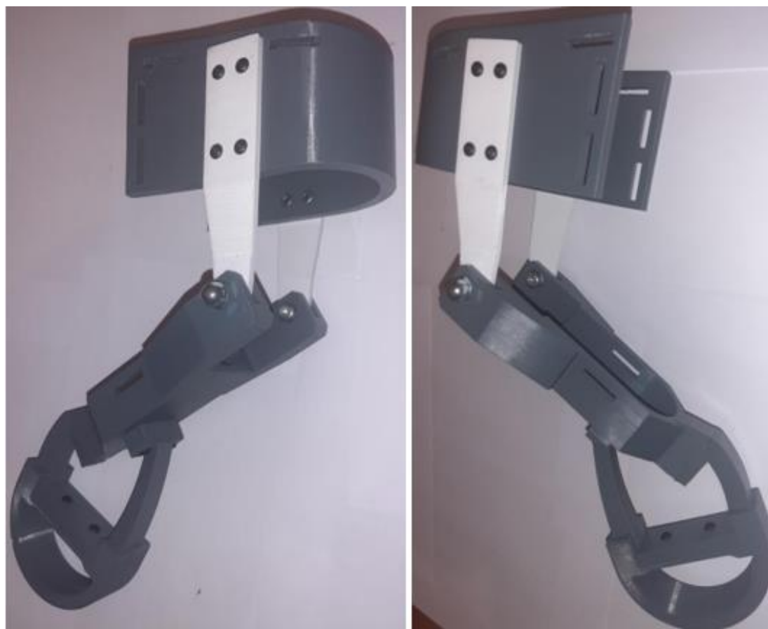
Slika 46. Sklopljeni prototip proteze
