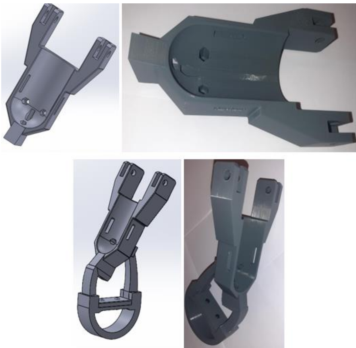
Slika 42. Prikaz čarapice i povezanog donjeg dijela proteze
