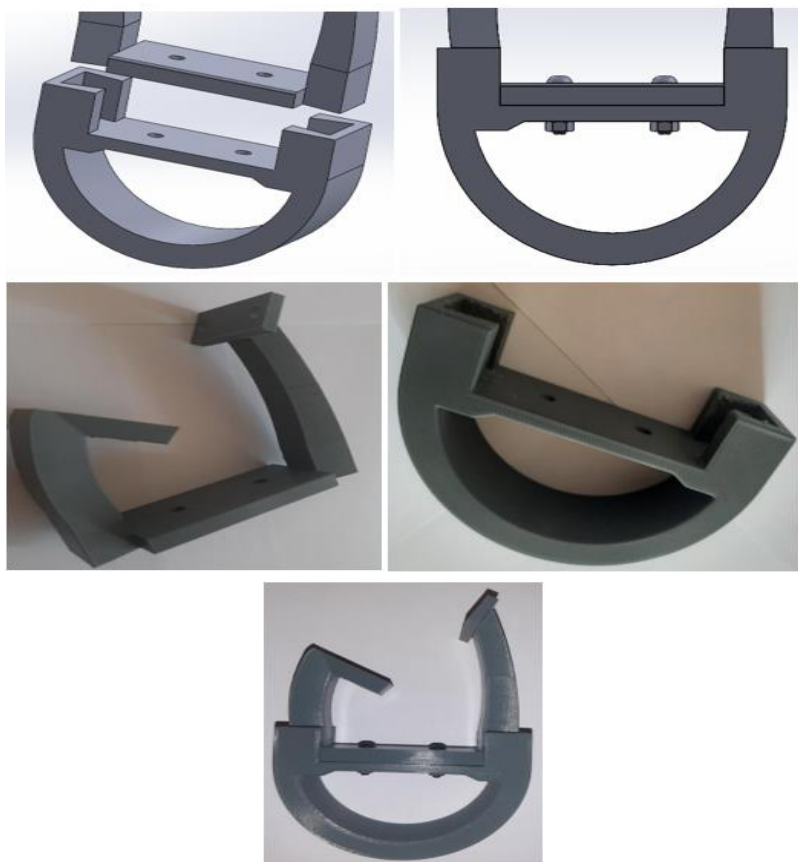
Slika 41. Prikaz proteznog stopala i „kostiju došaplja“
