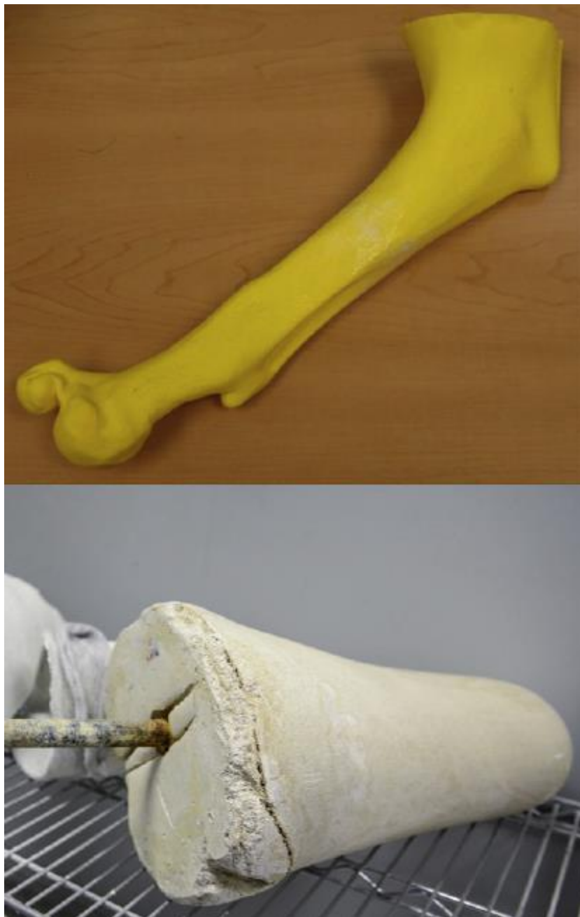
Slika 25. Model od ABS plastike dobiven 3D-printanjem (FDM-om) i model od gipsa [20]
