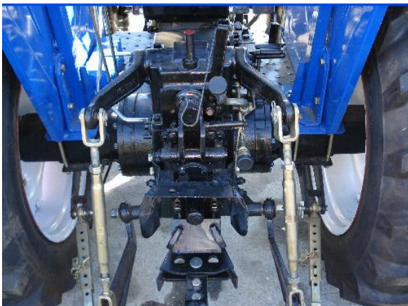
Slika 12. Položaj priključaka na traktor
