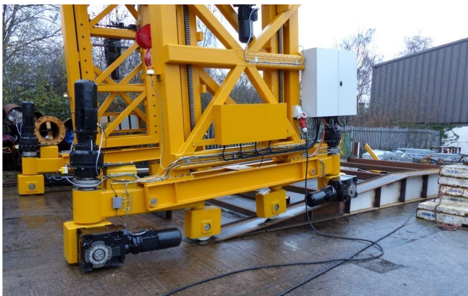
Slika 9 Samohodni portalni granik s mehanizmom za skretanje [5]
