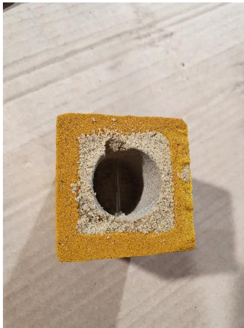
Slika 27. Quik-Cup čašica s termoparom za dobivanje krivulje hlađenja
