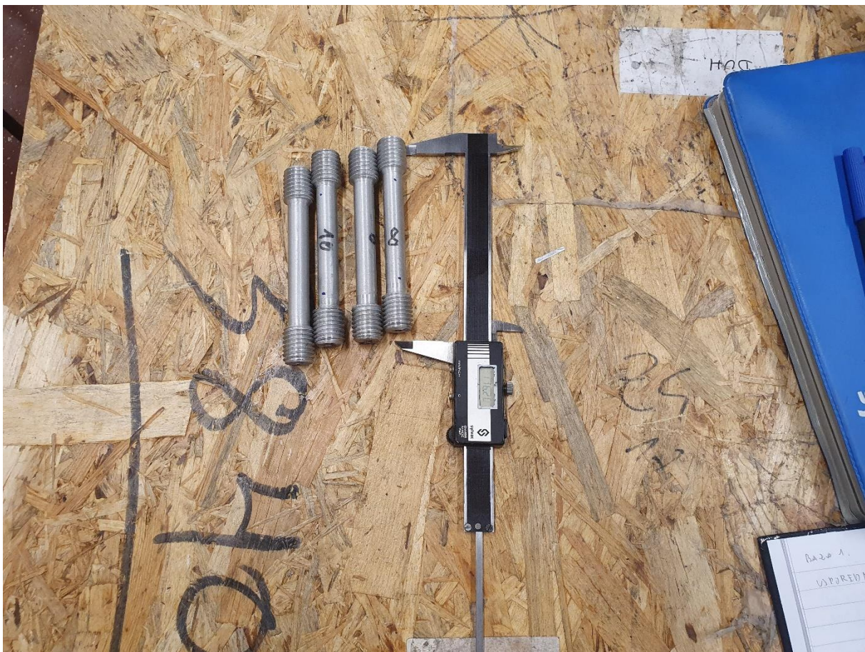
Slika 37. Uzorci prije statičkog vlačnog ispitivanja na kidalici
