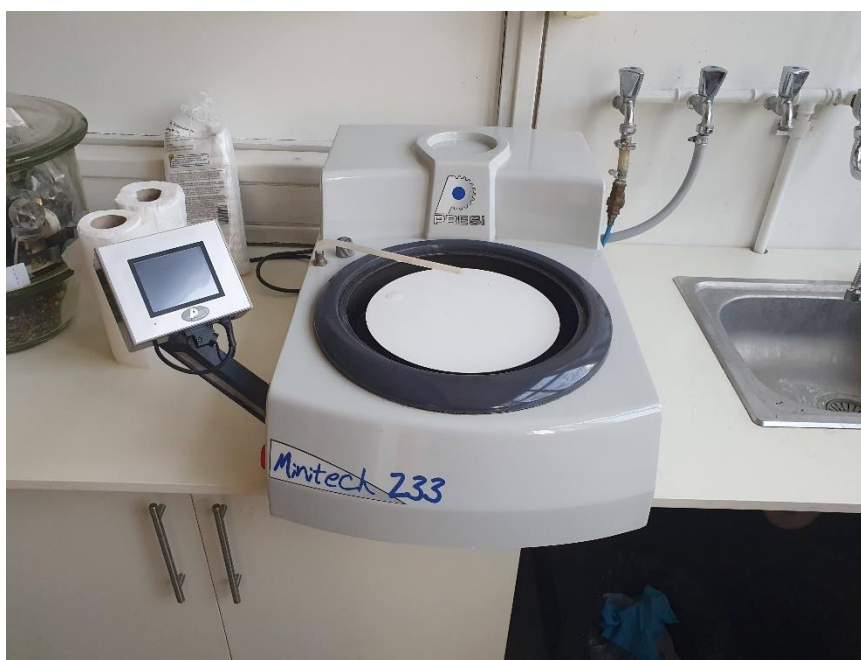
Slika 43. Uređaj za brušenje Mintech 233
