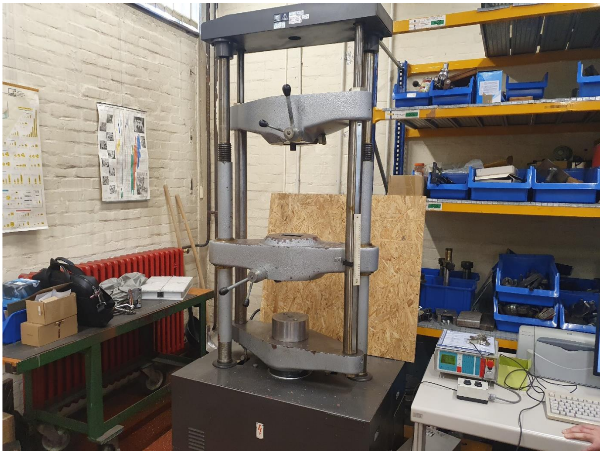
Slika 38. Kidalica Werkstoffprufmaschinen EU 40 mod
