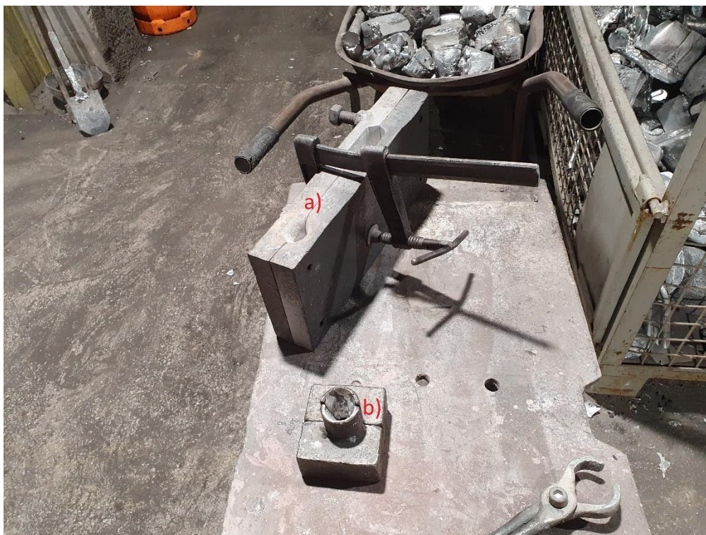
Slika 28. Kalupi za lijevanje uzoraka: a) Dvodjelna kokila za epruvetu za mehanička svojstva, b) Dvodjelna kokila za uzorak za ispitivanje kemijskog sastava
