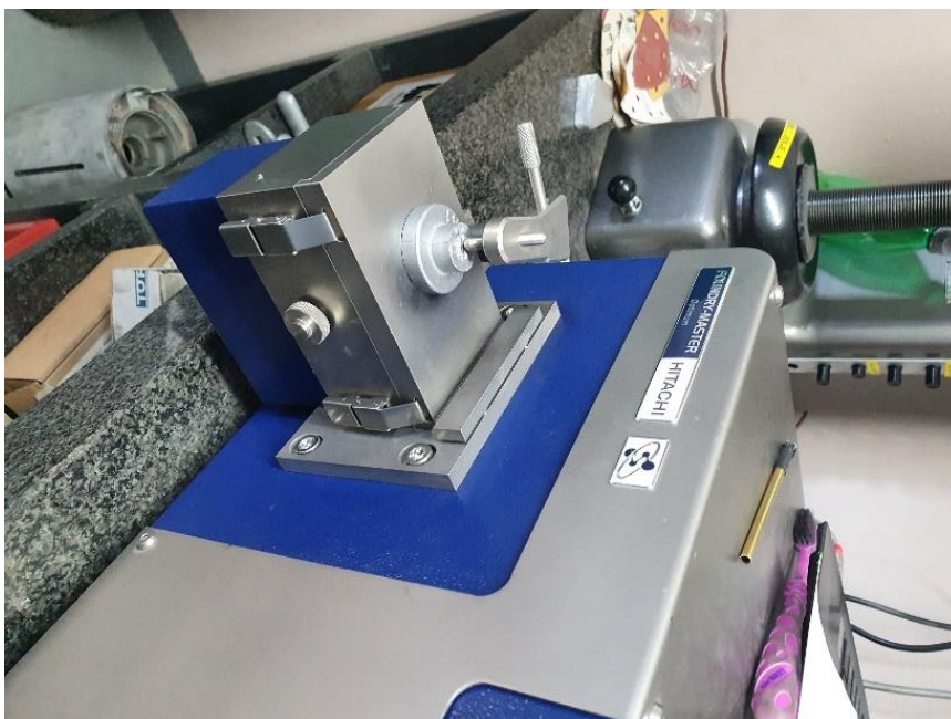
Slika 33. Uređaj Hitachi Foundry-Master za određivanje kemijskog sastava legure
