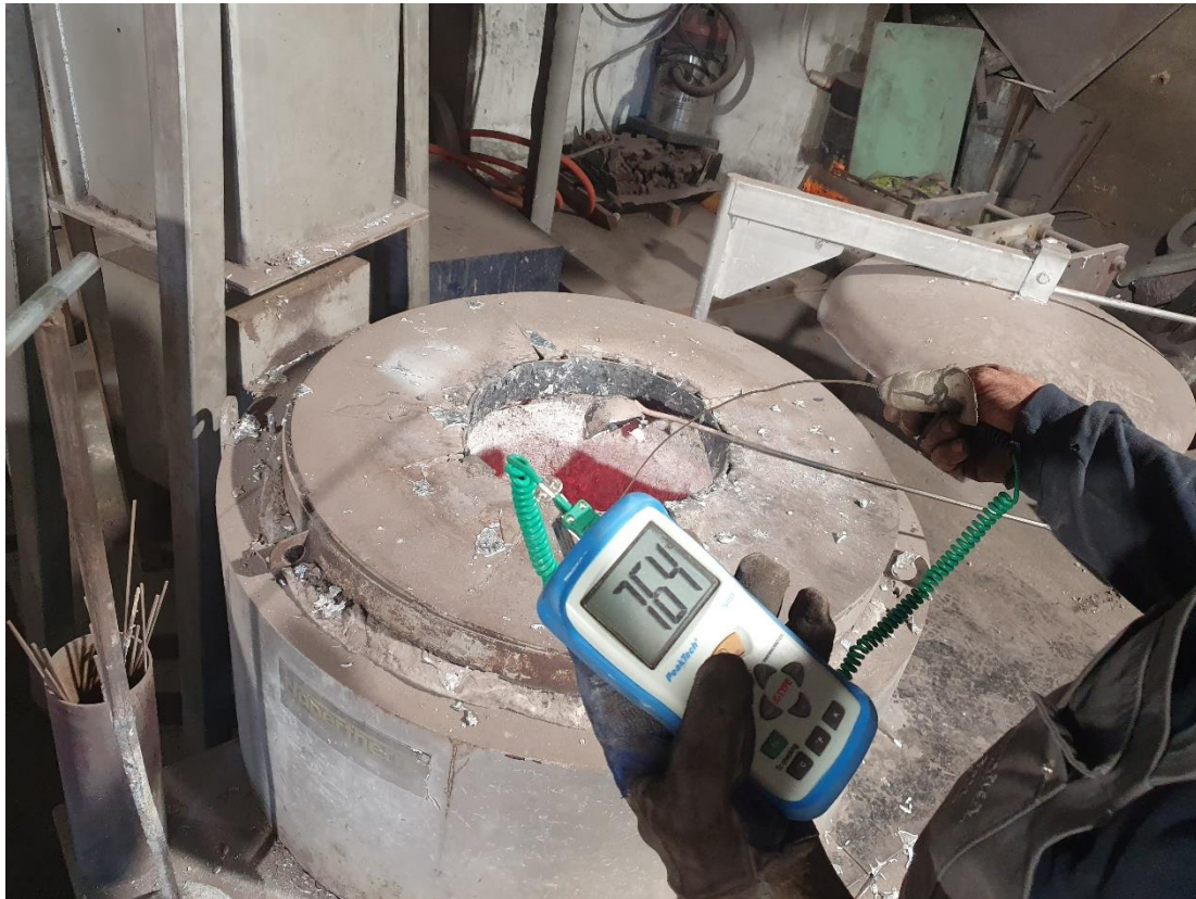
Slika 26. Bazna taljevina AlSi7Mg u peći pri temperaturi 764 °C
