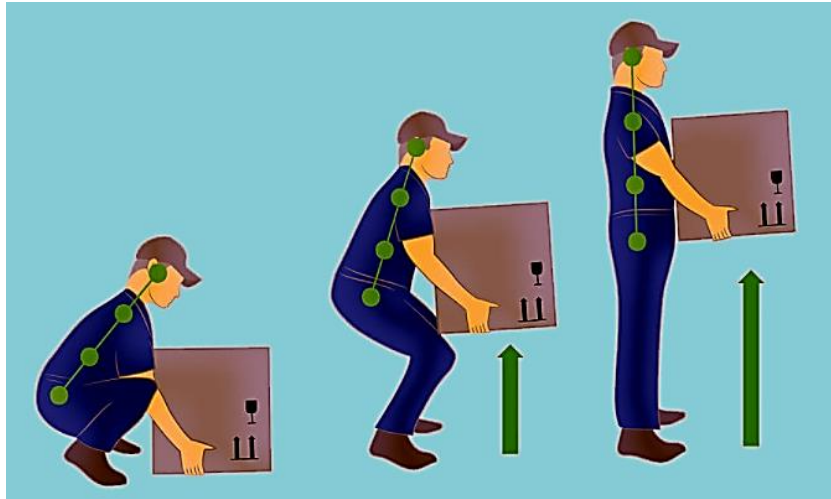
Slika 11. Pravilno podizanje tereta [12]
