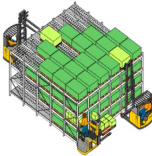
Slika 43. Prikaz komisioniranja paleta i kutija iz protočnih regala [29]
