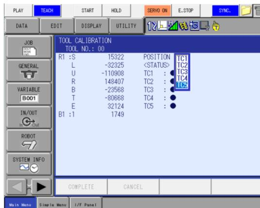
Slika 9. Proces kalibracije alata kod robota
