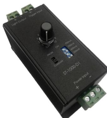
Slika 51. Kontroler za upravljanje industrijskim osvjetljenjem [14]
