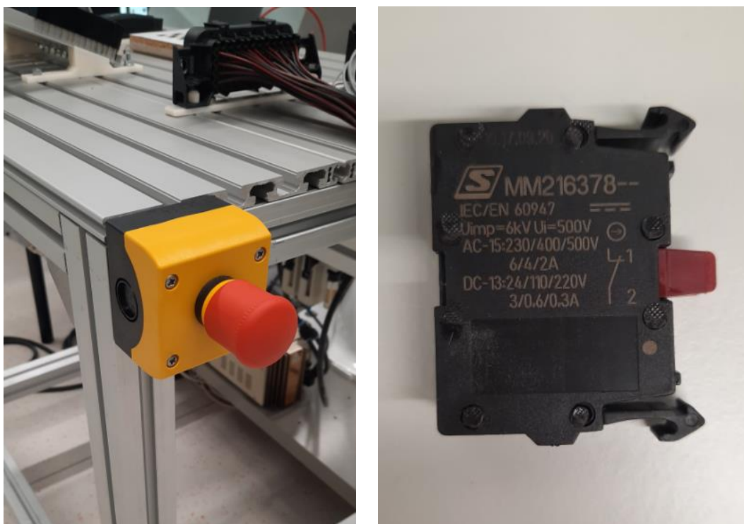
Slika 53. Sigurnosna stop tipka (lijevo) i NC sklopni element (desno)
