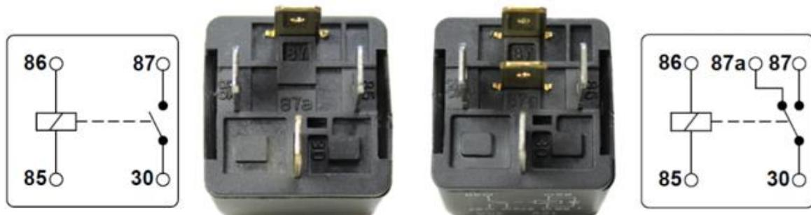
Slika 2. Relej s četiri pina (lijevo) i s pet pinova (desno)
