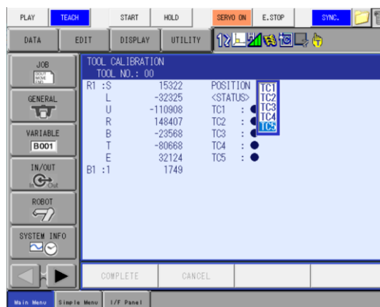
Slika 9. Proces kalibracije alata kod robota
