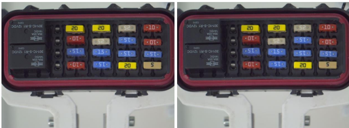
Slika 82. Usporedba slike s prisutnom distorzijom (lijevo) i dobivene slike bez distorzije (desno)
