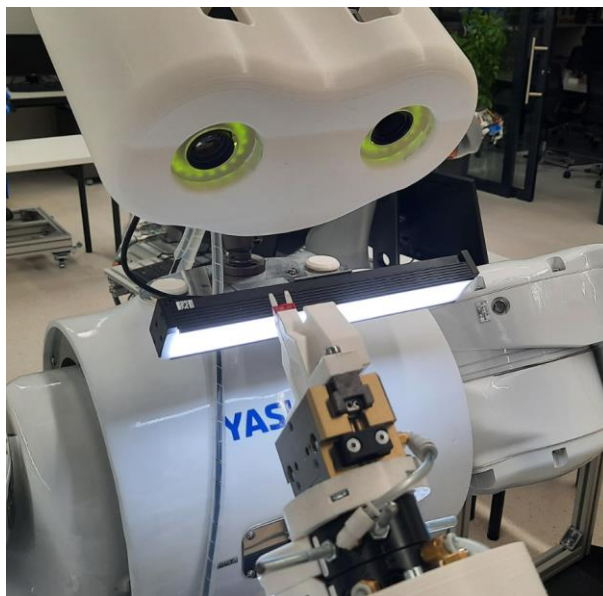
Slika 106. Vizijska inspekcija osigurača
