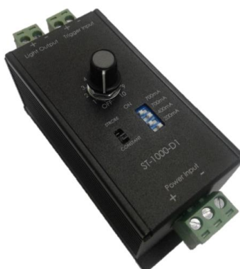
Slika 51. Kontroler za upravljanje industrijskim osvetljenjem [14]
