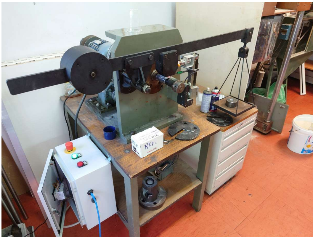
Slika 26. Uređaj za ispitivanje adhezijskog trošenja
