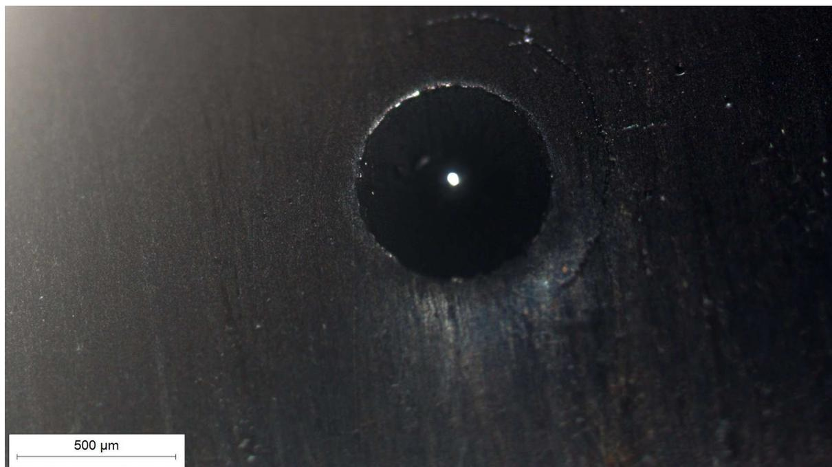
**Slika 32. Mjesto ispitivanja prionjivosti prevlake na prstenu P4**
