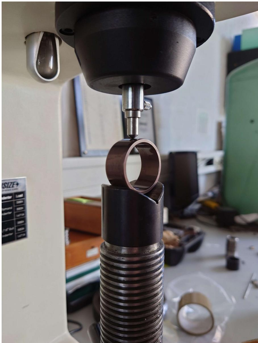
Slika 25. Ispitivanje prionjivosti prevlake dijamantrnim indentorom
