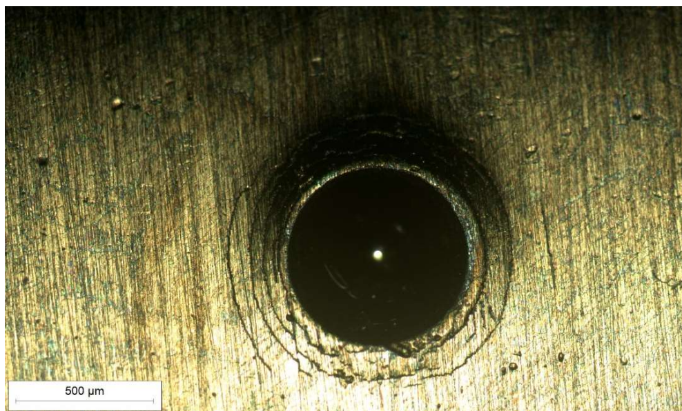
Slika 30. Mjesto ispitivanja prionjivosti prevlake na prstenu P2
