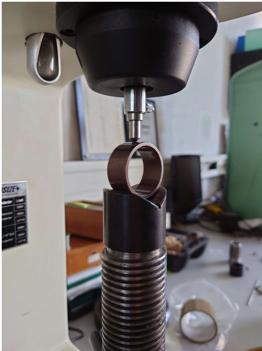
Slika 25. Ispitivanje prionjivosti prevlake dijamantrnim indenterom
