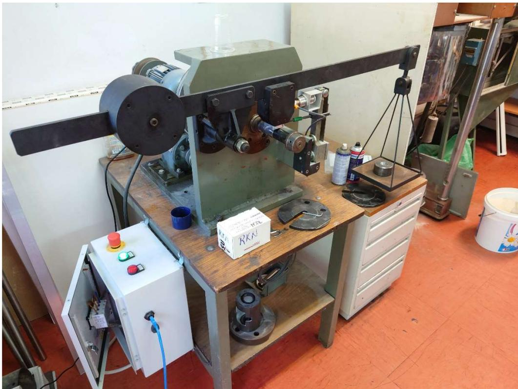
**Slika 26. Uređaj za ispitivanje adhezijskog trošenja**
