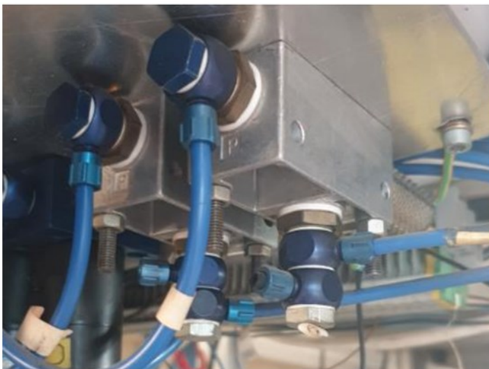
Slika 9. Dva VAD-1/4 generatora vakuuma s prigušnicama
