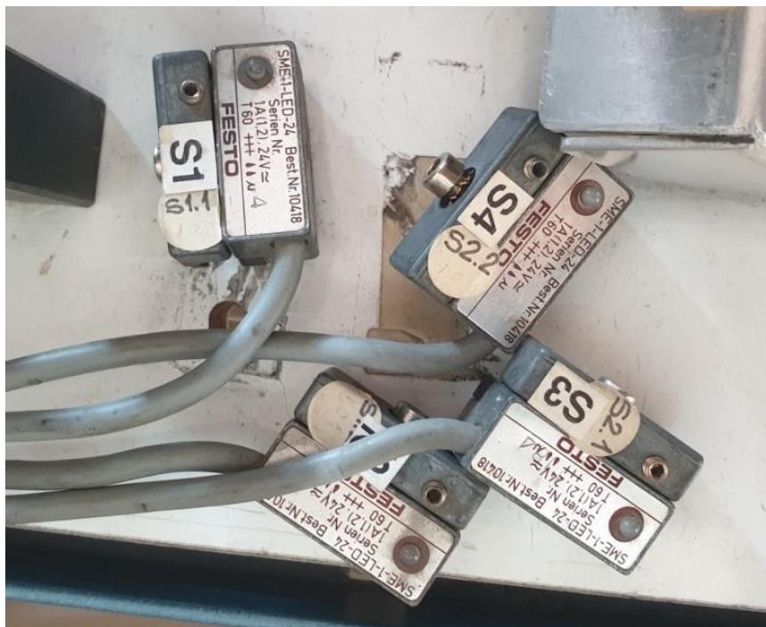
Slika 13. Induktivni senzori za poziciju klipa SME-1-LED-24
