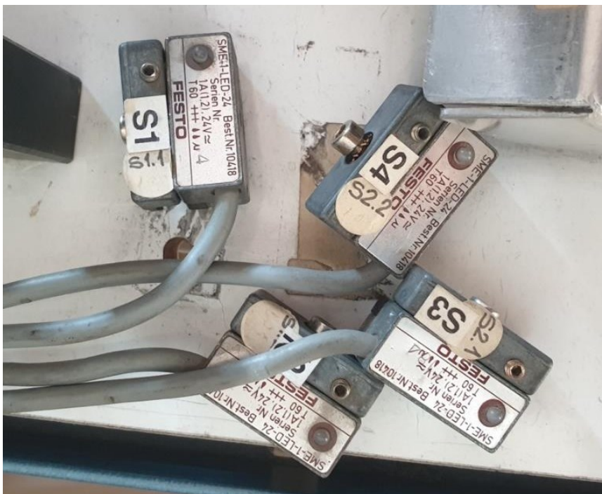
Slika 13. Induktivni senzori za poziciju klipa SME-1-LED-24
