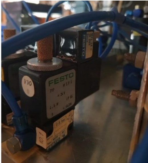
Slika 8. Pneumatski 3/2 ventil s elektromagnetskom zavojnicom
