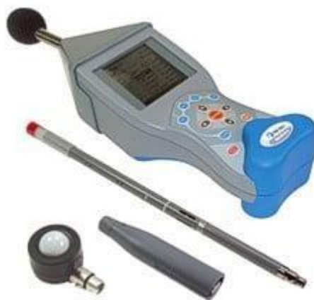
Slika 7. Metrel MI 6201 – univerzalni mjerni instrument
