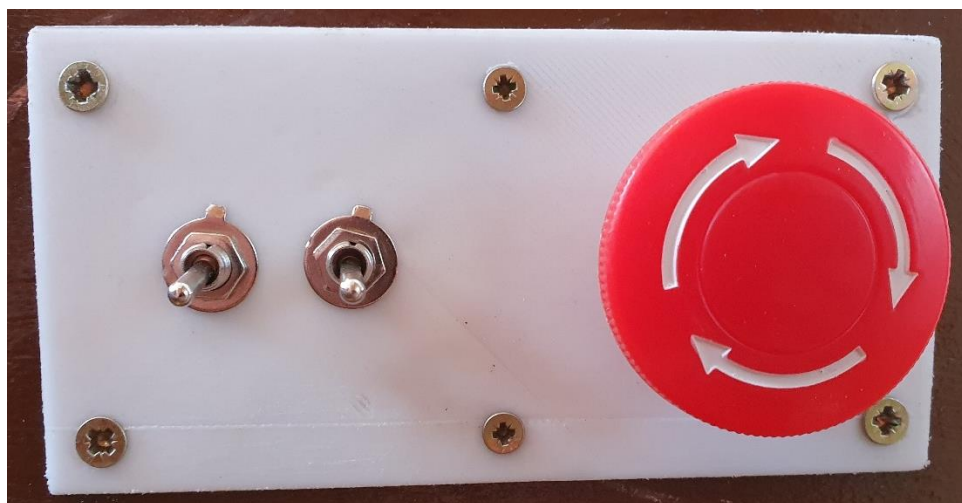
Slika 15. Sklopke i sigurnosna gljiva
