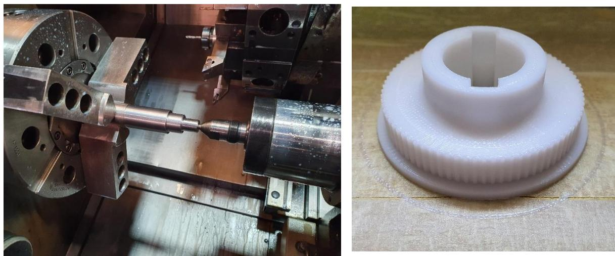
Slika 13. Tokarenje vratila baze robotske ruke (lijevo) i 3D ispis remenice (desno)
