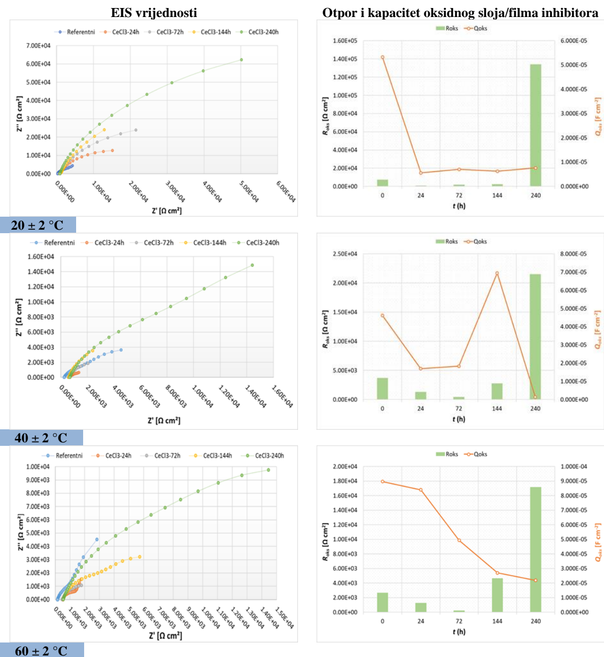
Slika 95. Nyquistov prikaz EIS eksperimentalnih vrijednosti inhibiranih i neinhibiranih uzoraka (lijevo); numeričke vrijednosti oksidnog sloja/filma inhibitora, otpora oksidnog sloja/filma inhibitora i kapaciteta električnog dvosloja (desno) nakon uranjanja u aeriranu 10 mM vodenu otopinu bez inhibitora i s inhibitorom (4 mM)
