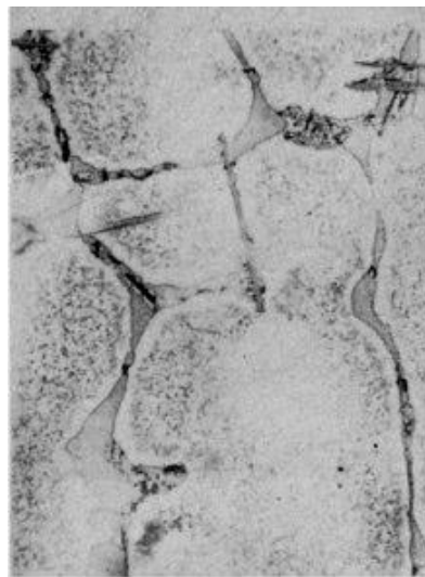
Slika 13. Prikaz krupnih čestica \text{Al}_2\text{Cu} po granicama zrna Al-Cu legure s 4 %Cu [55]
