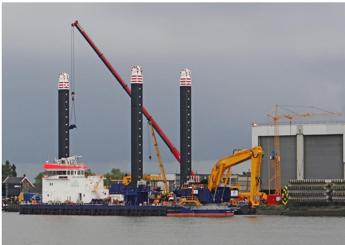
Slika 2-2 IHC Backhoe dredger u brodogradilištu
