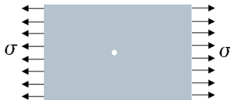
Slika 3. 33 Epruveta s malim kružnim otvorom u sredini opterećena naizmjenično
