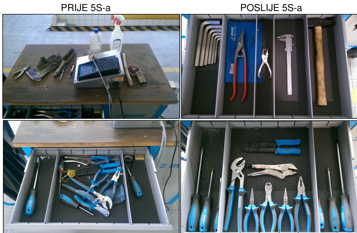
Slika 60. Loš i dobar primjer postavljanja na mjesto
