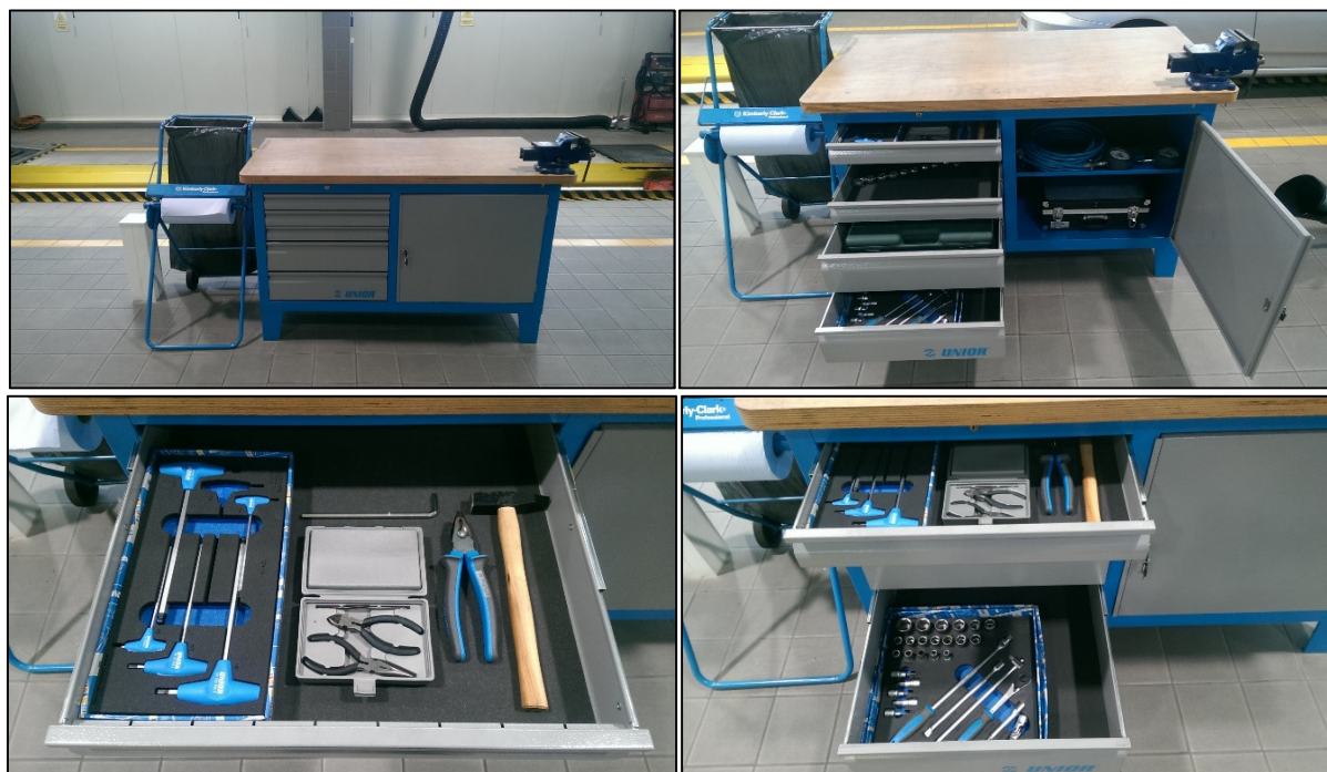
Slika 10. Radni stol s priručnim alatom na tehnološkoj liniji
