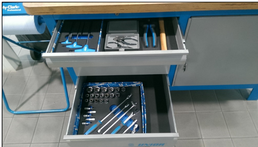
Slika 22. Radni stol i alat u pločama koje ocrtavaju njihov lik
