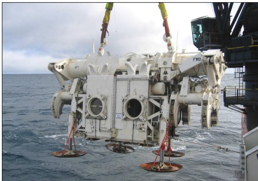
Slika 4.15 Zavarivačka komora PRS welding habitat [56]
