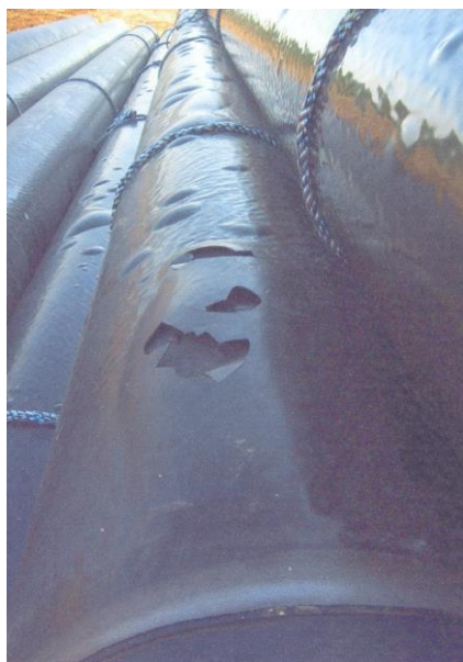
Slika 8.6 Deponija cijevi za plinovod Platforma Ivana K – Pula ( Kopneni dio ) Tvornička izolacija se na nekim mjestima napuhavala na suncu ( poliuretan – jednoslojni debljine 2 mm) [35]
