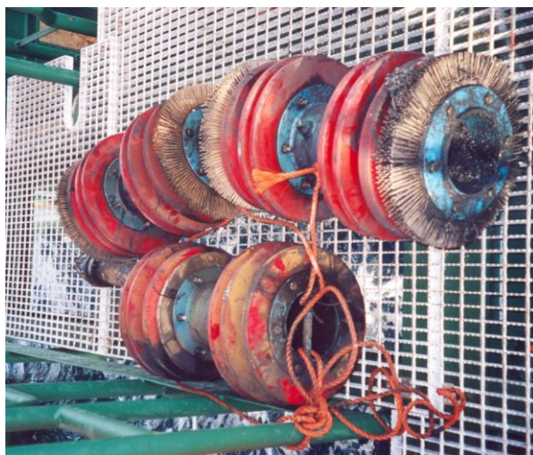
Slika 9.2 Čistači plinovoda sa žičanim četkama i kalibar pločom [46]
