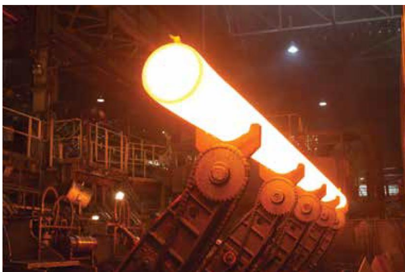
Slika 8.2 Proces proizvodnje bešavne cijevi [80]
