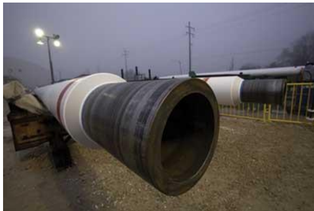
Slika 4.8 Kraj cijevi otežane betonskim prstenom [68]
