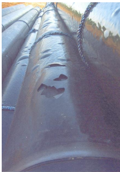
Slika 8.6 Deponija cijevi za plinovod Platforma Ivana K – Pula ( Kopneni dio ) Tvrnička izolacija se na nekim mjestima napuhavala na suncu ( poliuretan – jednoslojni debljine 2 mm) [35]
