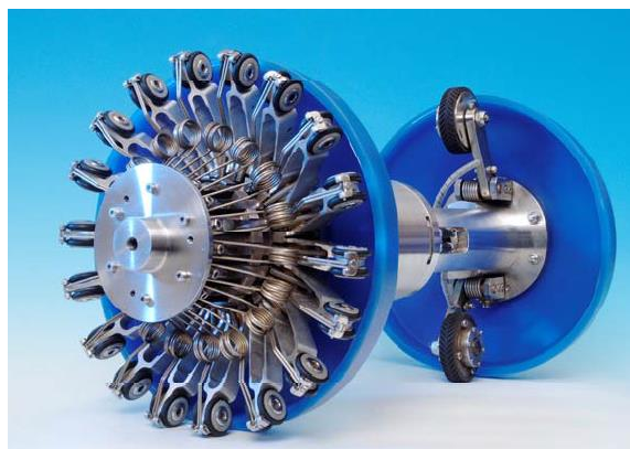
Slika 6.11 "In-line" uređaj za mjerenje geometrije [46]
