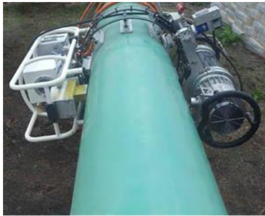
Slika 6.3 Uredaj za radiografsko ispitivanje [73]
