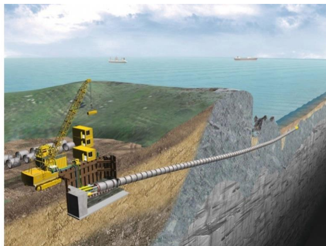
Slika 3.16 Profil horizontalno usmjerenog bušenja [67]
