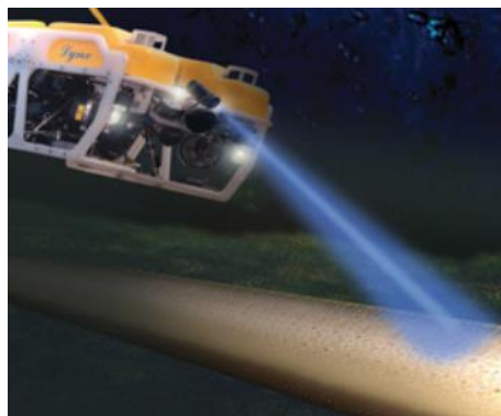
Slika 10.15 Daljinski upravljana podmornica sa ugrađenim flourometrom [45]
