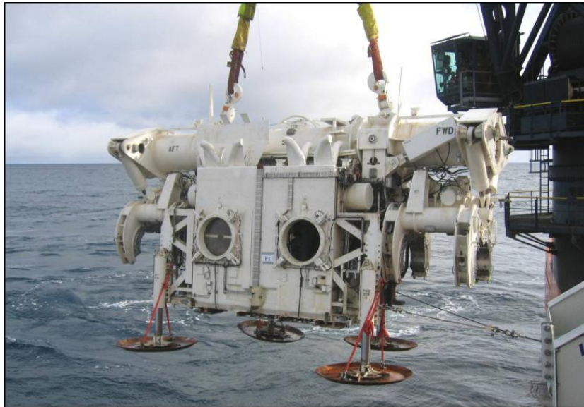
Slika 4.15 Zavarivačka komora PRS welding habitat [56]
