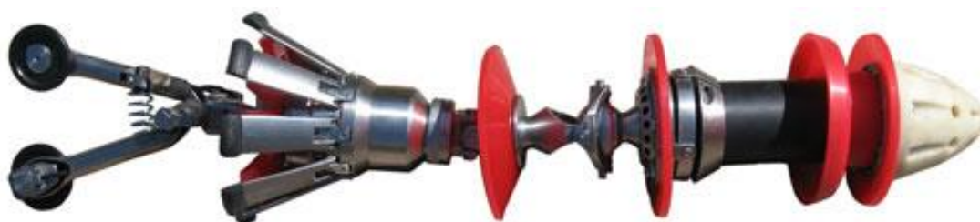
Slika 6.15 Elektro – mehanički uređaj za detekciju promjene geometrije [78]
