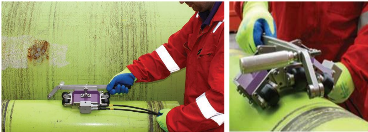
Slika 6.10 Ispitivanje MFL metodom [76]
