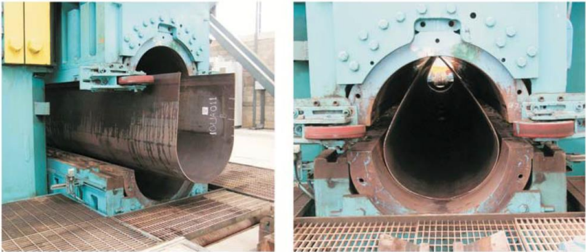
Slika 8.4 Preša za oblikovanje kružnog oblika [79]
