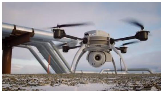
Slika 10.9 Dron s instaliranom kamerom i GPS sustavom navođenja [45]
