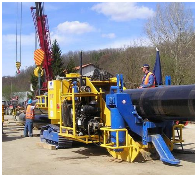
Slika 6.1 Savijanje cijevi DN 800 [33]
