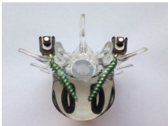
Slika 20. Pozicioniranje PLIF kaveza u modelu [15]
