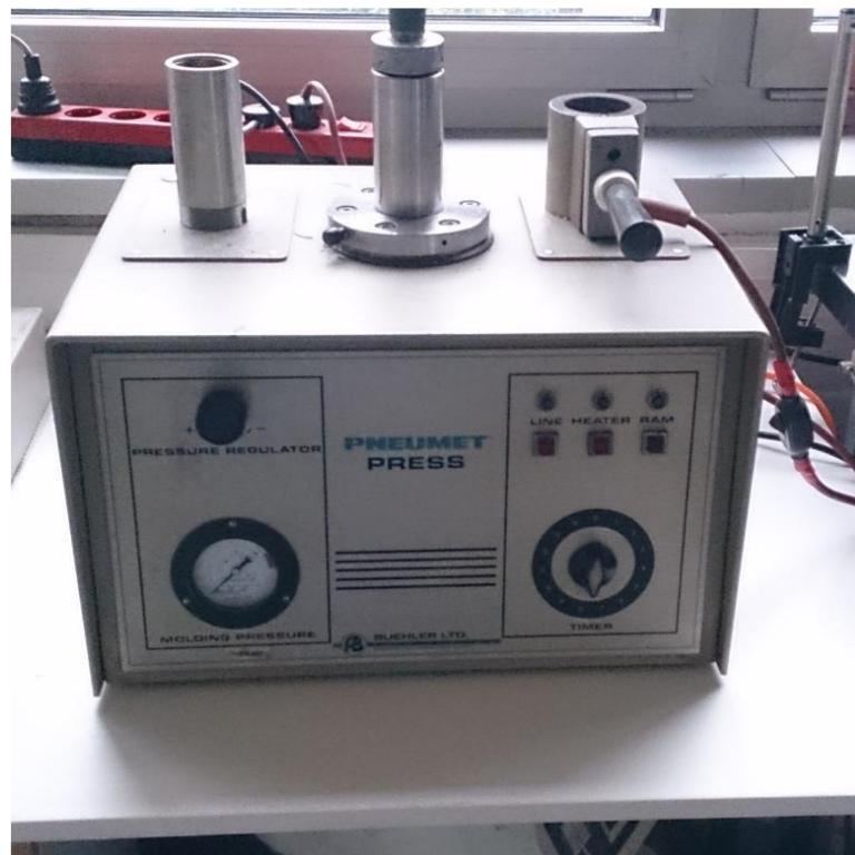
Slika 26. Buehler Ltd. Pneumet Press stroj za ulijevanje uzorka u polimernu smjesu
