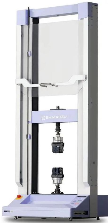
Slika 19. Shimadzu AGS – X kidalica [27]
