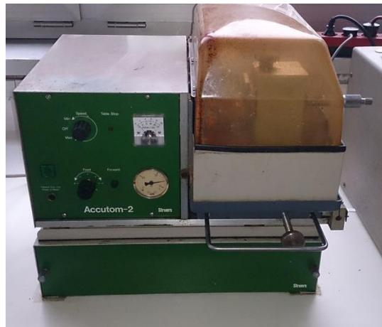
Slika 25. Struers Accutom-2 s vodenim hlađenjem rezalica
