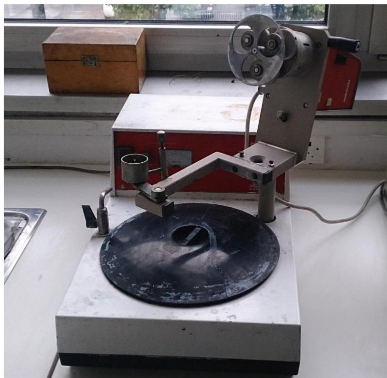
**Slika 28. Struers Pedemin stroj za brušenje**
