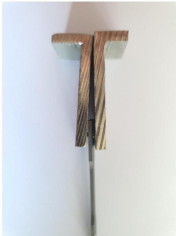
**Slika 24.** Prikaz montiranih profila za sprečavanje proklizavanja
