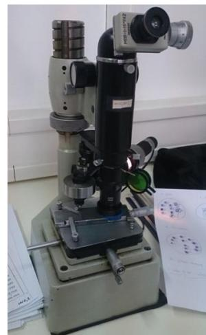
**Slika 32. Mikrotvrdomjeru PMT3**
