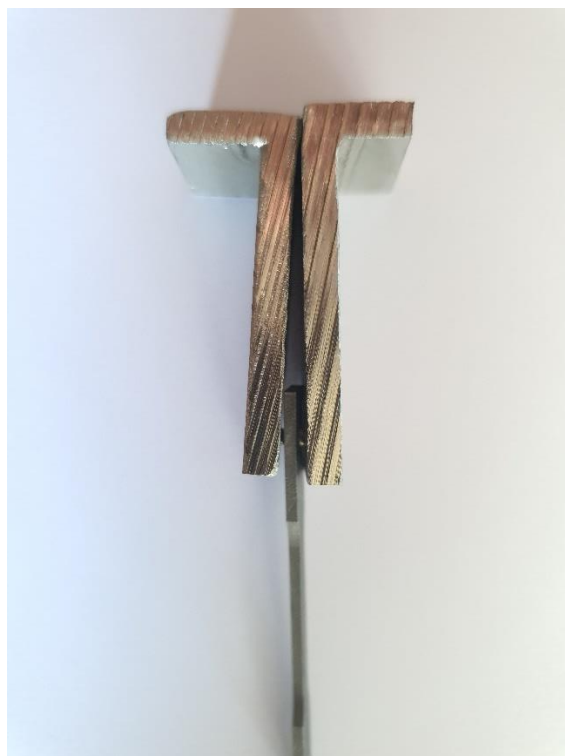
Slika 24. Prikaz montiranih profila za sprečavanje proklizavanja
